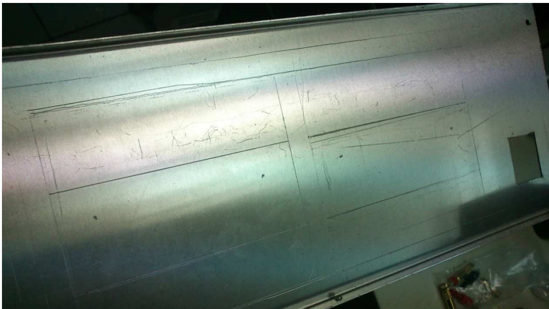
Εικόνα 9:Σχεδιασα τις διαστάσεις για τις Ψήκτρες
