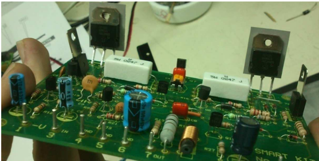
Εικόνα 1 :Βλέπουμε τα τρανζίστορ με το ειδικό μονωτικό πριν μπει στην Ψήκτρα
