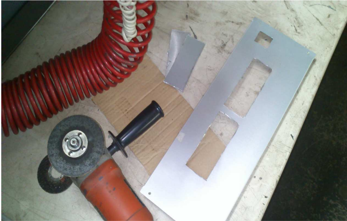
Εικόνα 10 :Με τον κατάλληλο τροχό τελειώνοντας τις τρύπες
