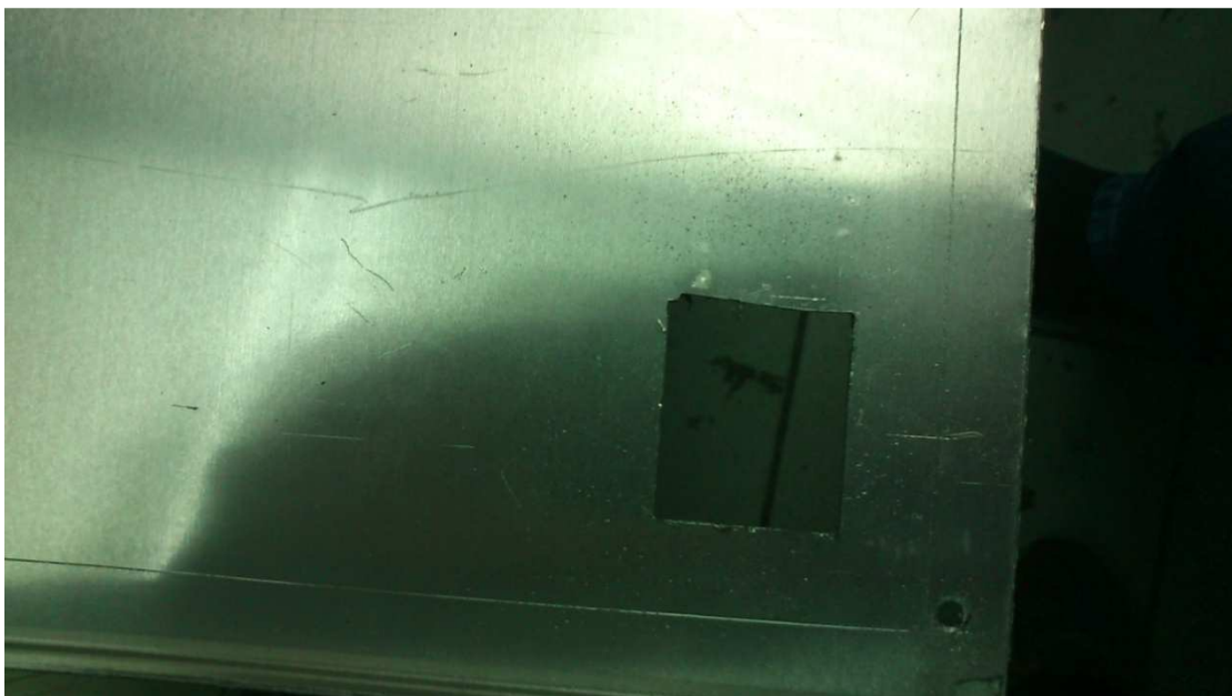
Εικόνα 5 : Τελειώνοντας το τρύπημα και το λιμάρισμα
