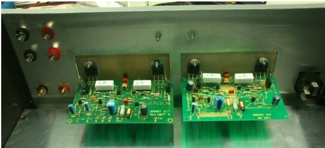
Εικόνα 1 : Τα τρανζίστορ βιδώθηκαν στις ψήκτρες
