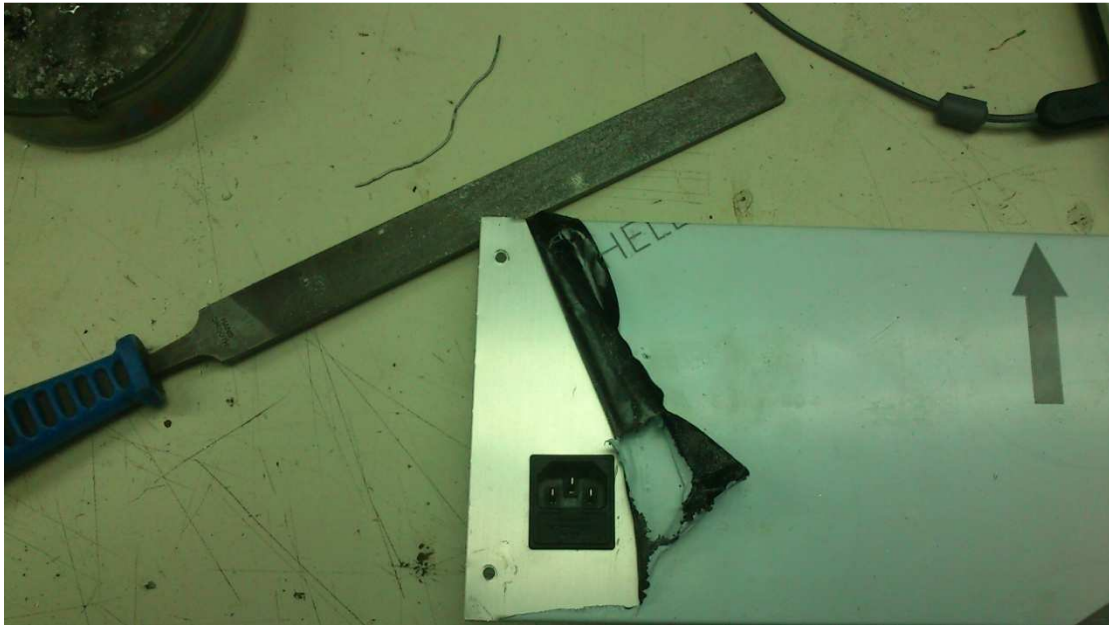
Εικόνα 6 : Τοποθέτηση βύσματος τροφοδοσίας
