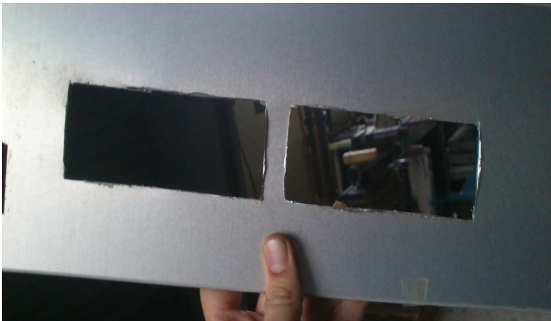
Εικόνα 11 :Πριν το λιμάρισμα
