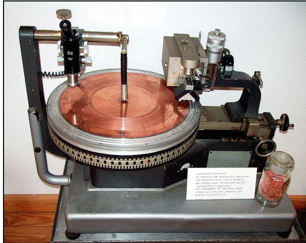
Εικόνα 3.24 - Ένας χάλκινος δίσκος τοποθετημένος στη μηχανή χάραξης Neumann AM131, η οποία κατασκευάστηκε τη δεκαετία του 1930.
