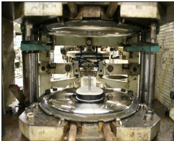
Εικόνα 3.23 - Τα stampers, το “μπισκότο” βινυλίου και οι ετικέτες τοποθετημένες στην πρέσα πριν συμπιεστούν για να παραχθεί ο δίσκος βινυλίου.
