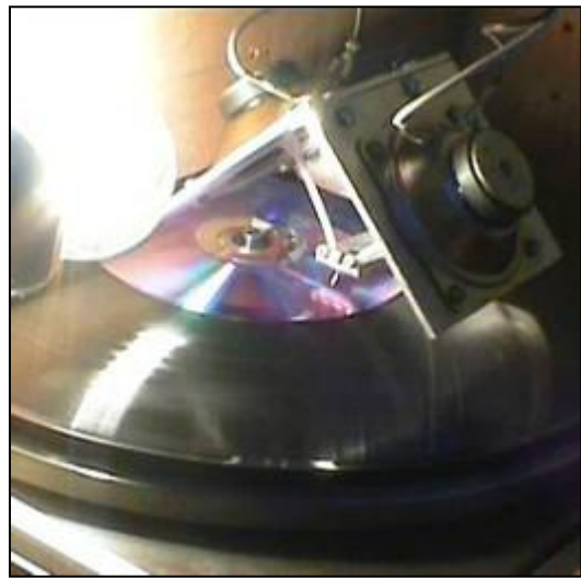
Εικόνα 3.22. - Χάραξη ενός CD με μία DIY κεφαλή χάραξης.
