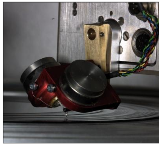
Εικόνα 3.25 - Μια κεφαλή χάραξης. Μοντέλο: Vinylium sc99
