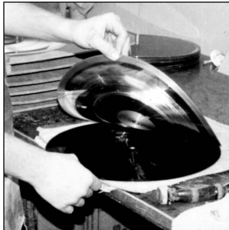
Εικόνα 3.20 - Ο διαχωρισμός του μεταλλικού αντίγραφου από το master lacquer.
