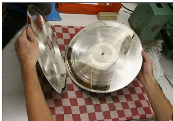
Εικόνα 3.22 - Διαχωρισμός του metal matrix και του metal mother
