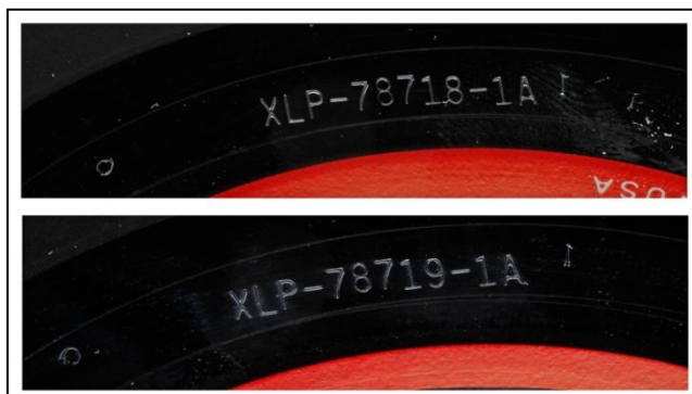
Εικόνα 5.41 - Παράδειγμα matrix number ανάμεσα στα εξωτερικά αυλάκια ενός δίσκου.
