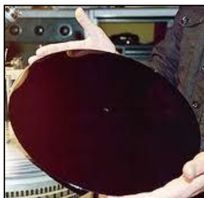
Εικόνα 3.19 - Ένας master lacquer δίσκος πριν από τη χάραξη
