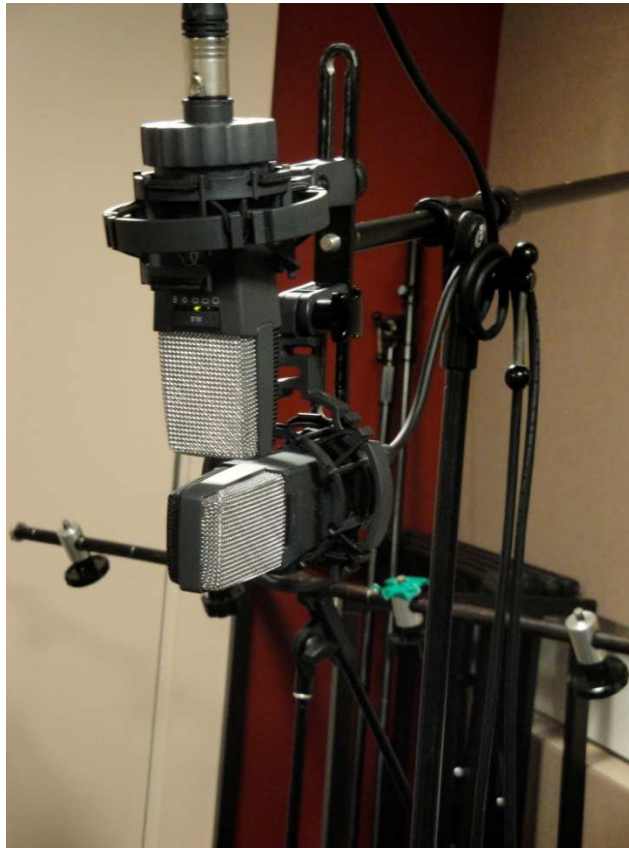
Εικόνα 3-4 Τεχνική MID-SIDE (M-S)
