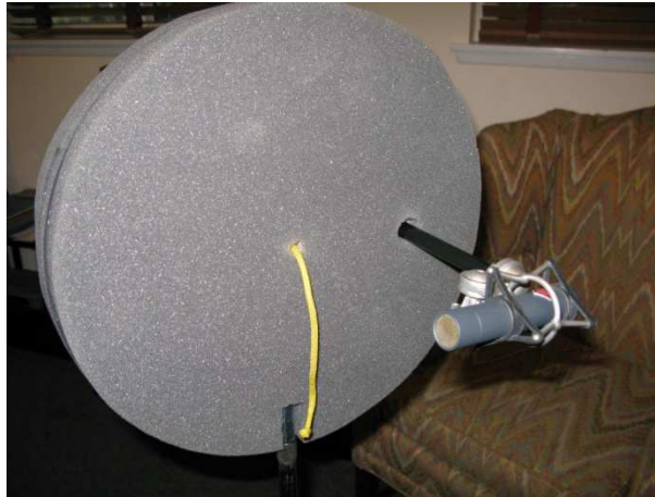
Εικόνα 3-8 Jecklin Disk για την binaural τεχνική
