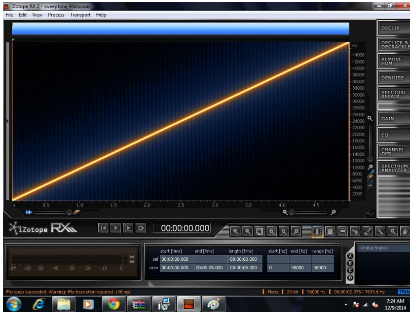
Σχήμα 37 : Παραμόρφωση aliasing πειραματικού ηχητικού δείγματος β ανάλυσης 96KHz 24bit
