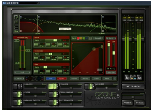
Εικ. 4.20 Ο multiband compressor που χρησιμοποιήθηκε για το mastering
