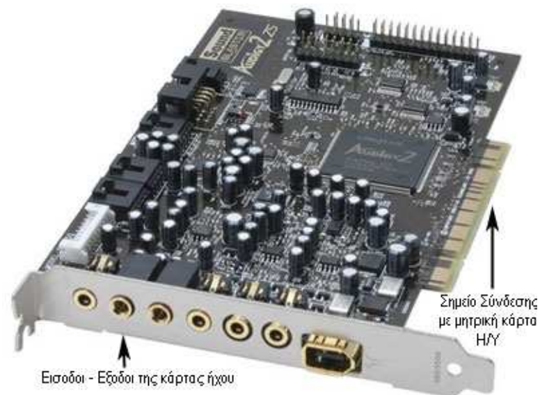
Εικόνα 71. Κάρτα ήχου. HOWSTUFFWORKS, < http://computer.howstuffworks.com/sound-card.htm >
