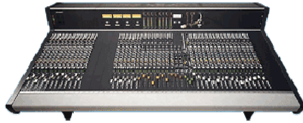
Εικόνα 35. Κονσόλα 928, της εταιρίας Studer, κατάλληλη για στούντιο ηχογράφησης, συναυλίες και μεγάλες ηχητικές παραγωγές. STUDER, < http://www.studer.ch/index.aspx? >
