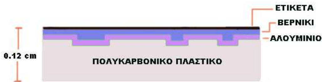
Εικόνα 52. Τα υλικά που χρησιμοποιούνται για την κατασκευή ενός οπτικού δίσκου
