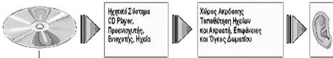
Ε3.1.1 Διάγραμμα ηλεκτροακουστικού συστήματος
