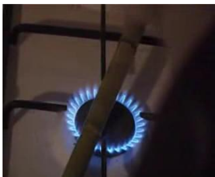
Εικόνα 2.3 Ίσιωμα με φωτιά
