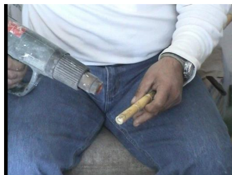
Εικόνα 2.4 Ίσιωμα με ζεστό αέρα
