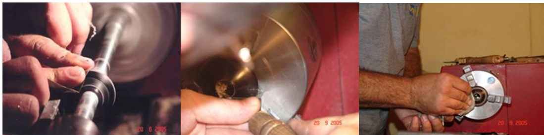
Εικόνες 2.15 Τα στάδια κατασκευής ενός μπασπαρέ από κέρατο
