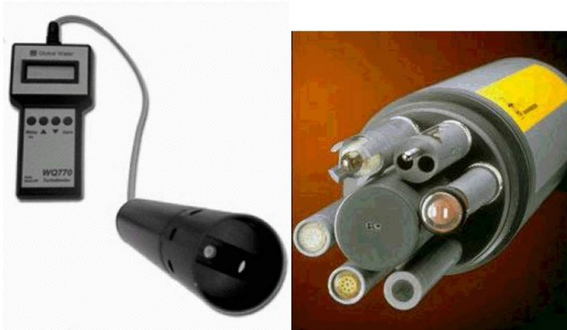
Σχήμα 8. Αισθητήρες μέτρησης της θολερότητας σε υδατικά περιβάλλοντα.
