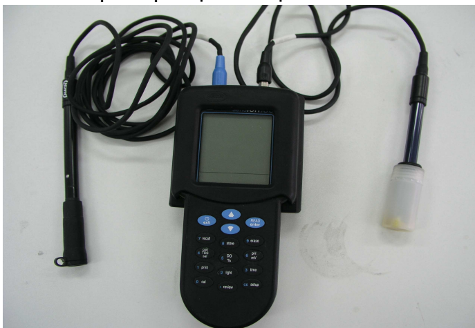
Εικόνα 6. Η συσκευή HACH και τα προσαρμοσμένα ηλεκτρόδια pH και DO
