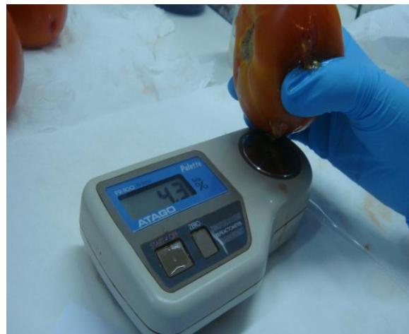
Εικόνα 10: Διαθλασίμετρο (Palette-Atago PR100).
