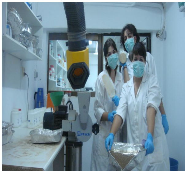
Εικόνα 6: Δείγμα εδάφους σε ταψί αλουμινίου μετά την ξήρανση και άλεση του.
