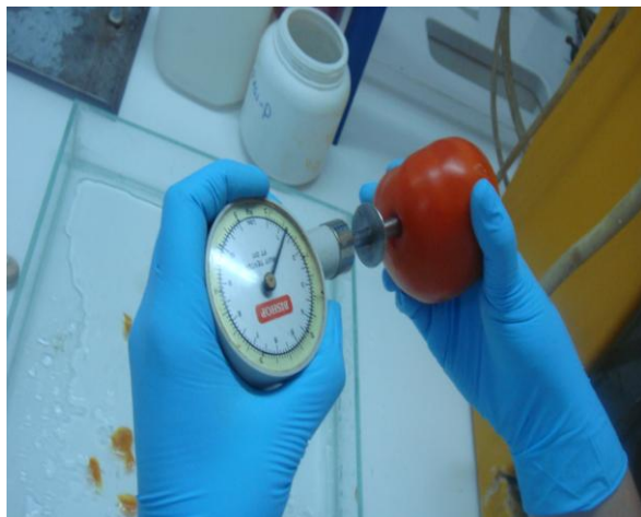
Εικόνα 9: Πενεντόμετρο (Bishop FT model 011).
