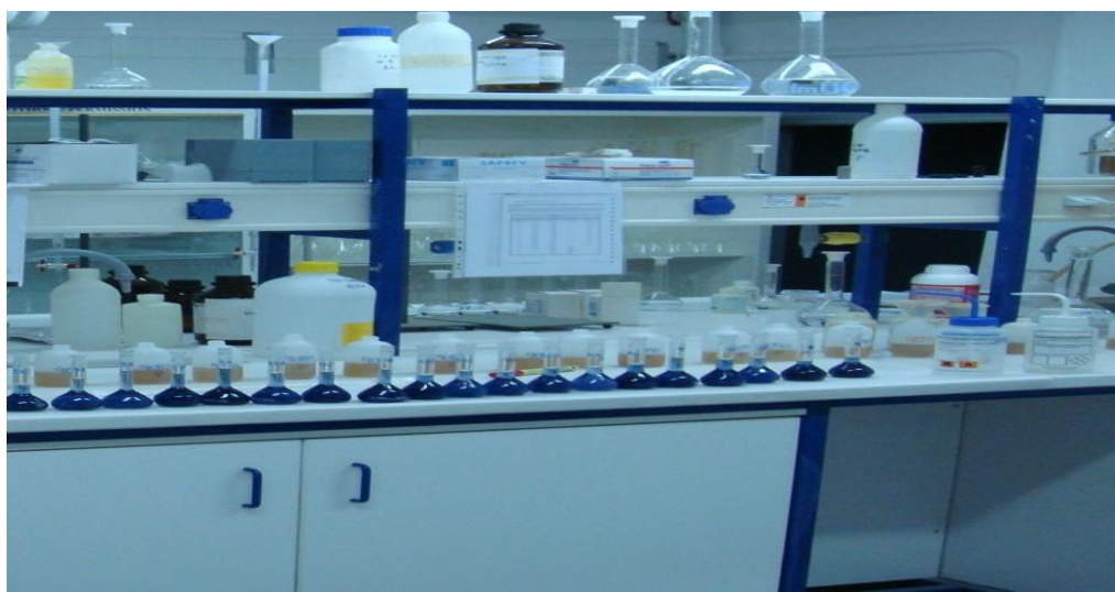
Εικόνα 7: Ανάπτυξη του κυανού χρώματος για τον προσδιορισμό αφομοιώσιμου φωσφόρου.
