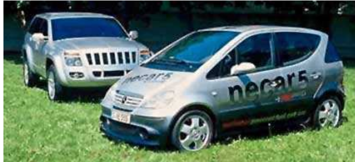
Σχήμα 20 : Δύο πρωτότυπα αυτοκίνητα, που κινούνται με κυψέλη καυσίμου, το NECAR 5 και το JEEP Commander, από την DaimlerChrysler
