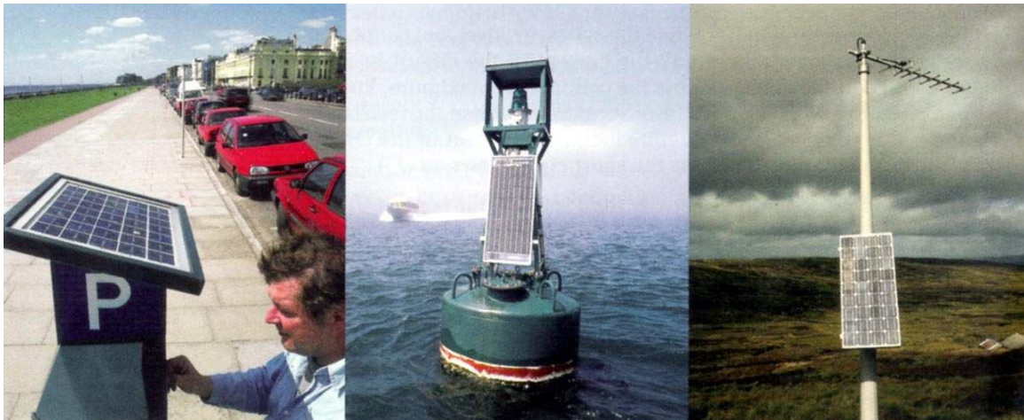
Σχήμα 41 : (αριστερά) Φ/Β παρκόμετρο, (μέση) σημαδόυρα ναυσιπλοΐας, (δεξιά) τηλεμετρικό σύστημα.
