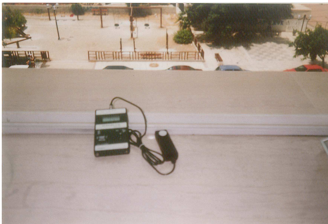
Εικόνα 3: Πυρανόμετρο για τη μέτρηση της έντασης της ηλιακής ακτινοβολίας
