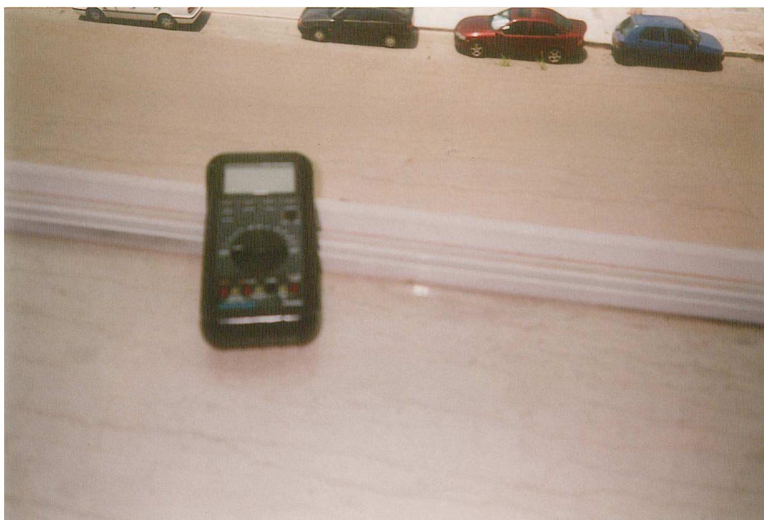
Εικόνα 4: Πολύμετρο για τη μέτρηση τάσεων και αντιστάσεων
