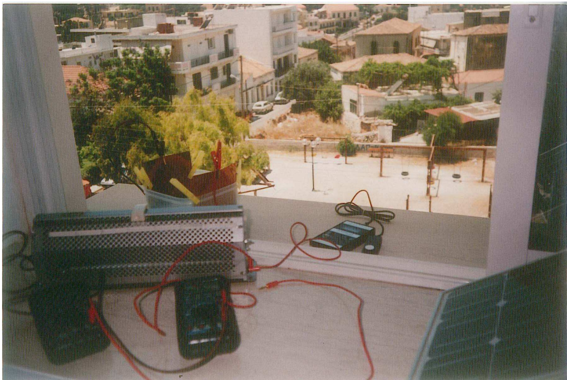
Εικόνα 10: Διάταξη φ/β στοιχείου διαστάσεων 15,2*15,2 \text{ cm}^2 με μεταβλητή αντίσταση και μέτρηση αυτής και της τάσης με τη βοήθεια πολύμετρου
