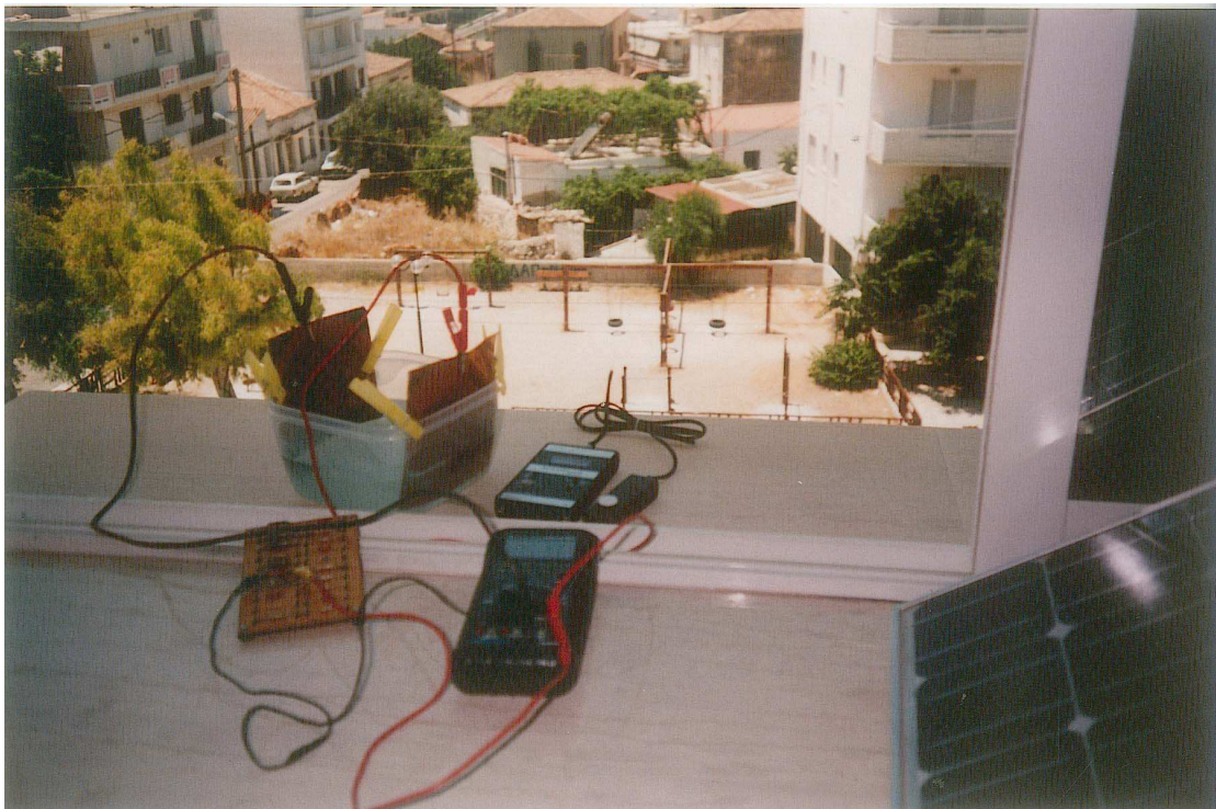
Εικόνα 9: Διάταξη φ/β στοιχείου διαστάσεων 15,2*15,2 \text{ cm}^2 με γνωστή αντίσταση και μέτρηση της τάσης με τη βοήθεια πολύμετρου
