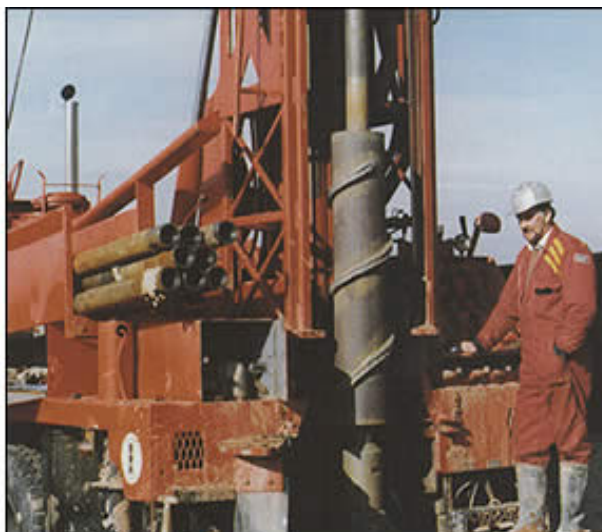
Μηχάνημα διάτρησης που χρησιμοποιείται για την περιστροφική γεώτρηση .
