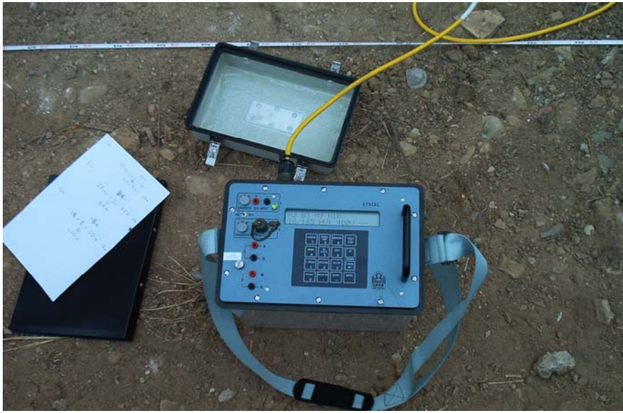
Όργανο που χρησιμοποιείται στις ηλεκτρικές μεθόδους βυθοσκόπησης για την καταγραφή των λαμβανόμενων μετρήσεων .
