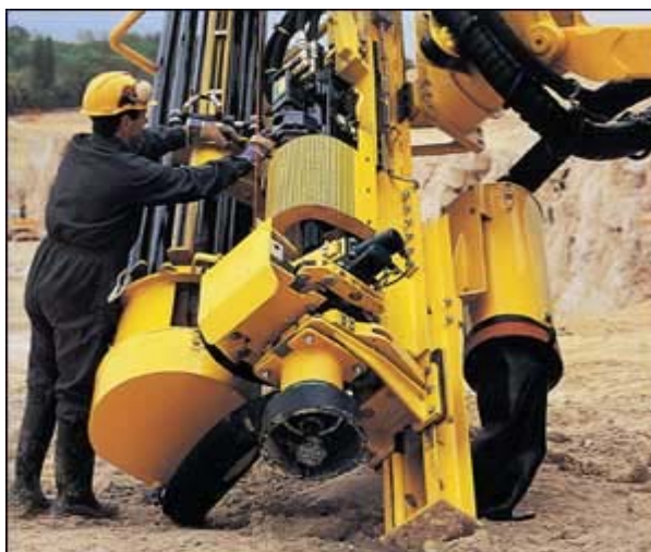
Μηχάνημα διάτρησης που χρησιμοποιείται για την κρουστική γεώτρηση .
