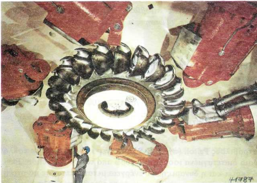
Εικόνα 4.9. Τροχός Pelton με 6 ακροφύσια [7]. Φαίνονται οι κωνικές βελόνες των βελονοειδών βαλβίδων και οι ανακλαστήρες της δέσμης νερού. H=1233\text{ m} , P=260\text{ MW} , D=2,85\text{ m} , \eta=300/\text{min} .
