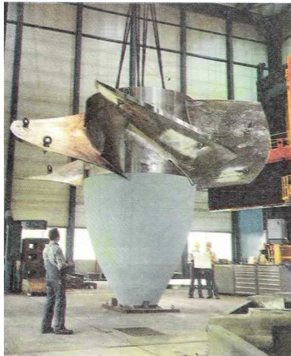
Εικόνα 4.12. Τροχός Karlan που ανήκει στην εικ. 4.10.[7] Διάμετρος 7,1 m
