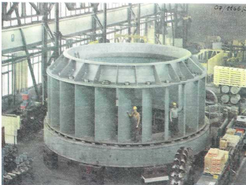
Εικόνα 4.11. Ακίνητα ρυθμιζόμενα πτερύγια τύπου Kaplan [7]. H=29,3 m, P=102,7 MW, n=93,75 /min
