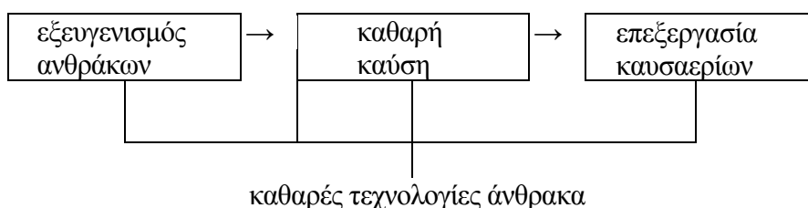
Σχήμα 5.1. Σχεδιάγραμμα βελτιωτικών τεχνολογιών καύσης άνθρακα για μείωση των εκπομπών ρύπων [10].
