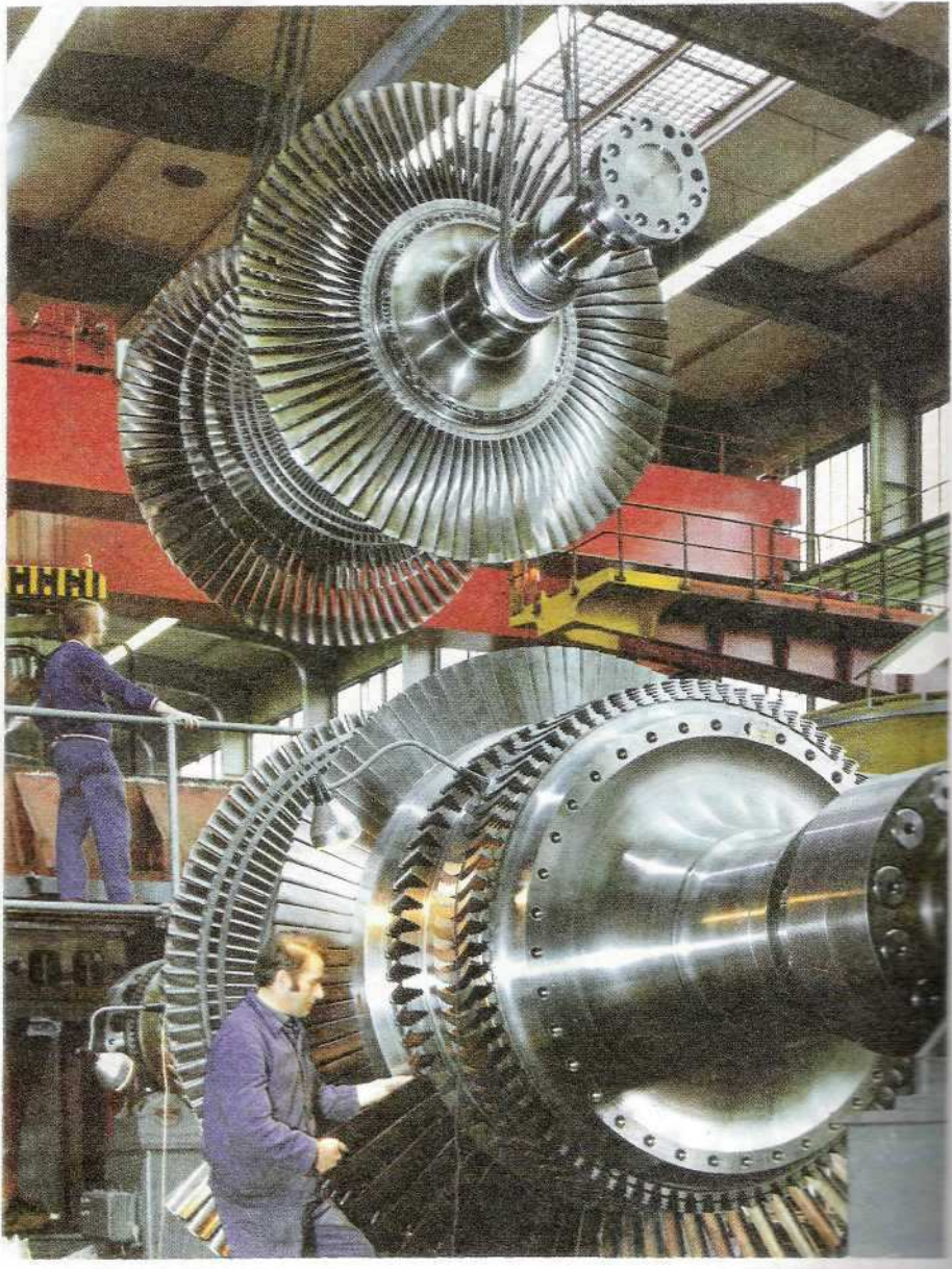
Εικόνα 4.2. Στρεφόμενα πτερύγια στροβίλου [7]. Πάνω είναι ο δρομέας μέσης και κάτω ο δρομέας χαμηλής πίεσης
