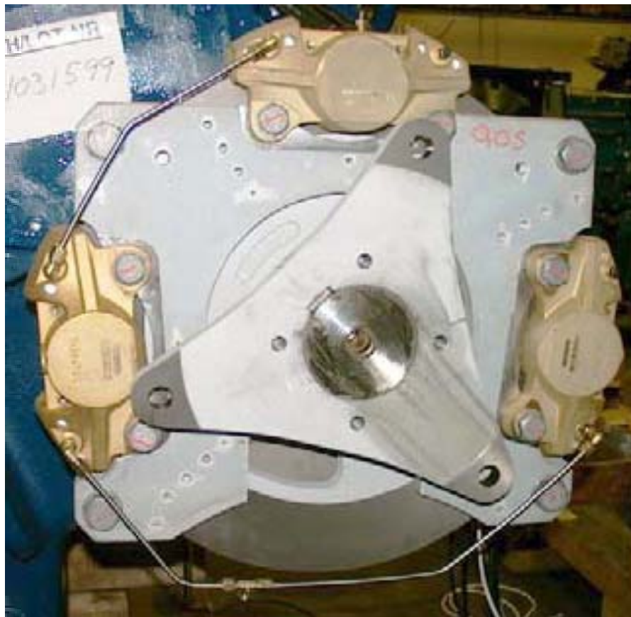
Σχήμα 2.13 Φωτογραφία ολοκλήρου του συστήματος φρένου ,τοποθετημένο στον άξονα σύνδεσης της γεννήτριας.
