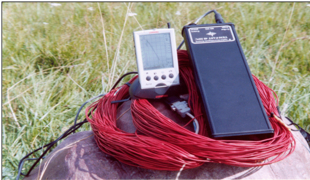
Εικόνα 3.6: Δείγμα οργάνου TEM- FAST 48 (APPLIED ELECTROMAGNETIC RESEARCH (AEMR) TEM -FAST 48HPC, aemr.net, 2010)
