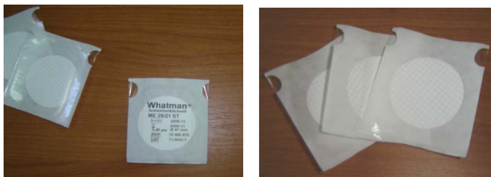
Εικόνες 5.2.14.3 α,β : Ηθμοί κυταρρίνης με μέγεθος ανοίγματος 0,45 \mu\text{m} (Whatman)
