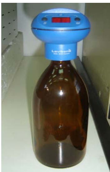
Εικόνα 5.2.6.3: Σκουρόχρωμη φιάλη & Κεφαλή ψηφιακού αισθητήρα του B.O.D.
