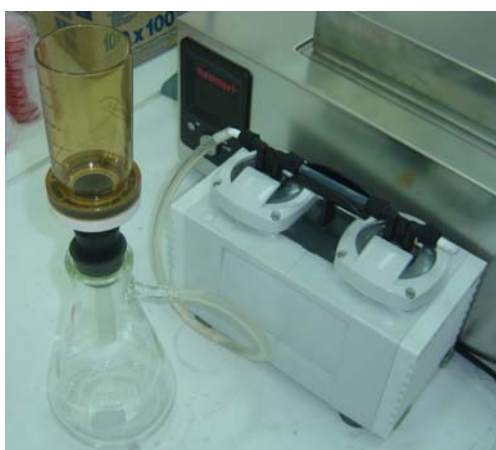
Εικόνα 5.2.14.1 : Αντλία κενού ( Buchi Vac® V-500 ) & μαγνητική χοάνη διήθησης
