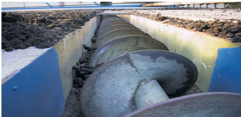
Σχήμα 3.7: Το κυλινδρικό τύμπανο ανάμιξης της λάσπης: Wendewolf
