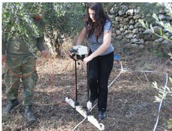
Σχήμα 2.2 Ηλεκτρομαγνητική διασκόπηση για χαρτογράφηση αρχαιολογικού χώρου
