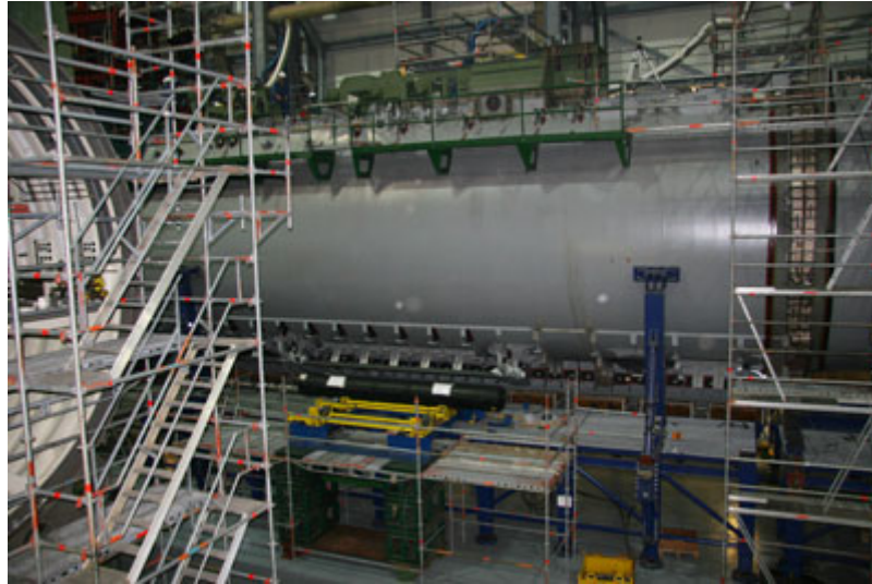
Κύλινδροι αποθήκευσης υδρογόνου στην τρόπιδα του μελλοντικού υποβρυχίου ΜΑΤΡΩΖΟΣ (S122) του ΠΝ, στο Κτίριο Υποβρυγίων των Ελληνικών Ναυπηγείων ΑΕ
