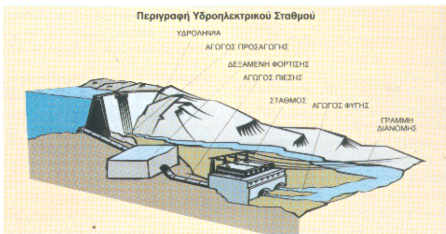
Σχήμα 10.4. Σχέδιο λειτουργίας εγκατάστασης μικρού υδροηλεκτρικού συστήματος
