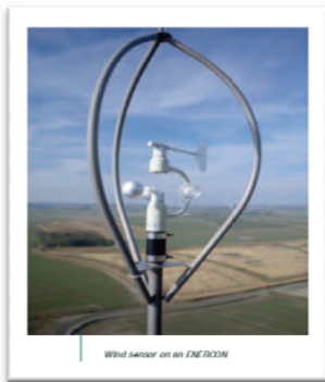
Ανεμόμετρο με ανεμοδείκτη της Enercon
