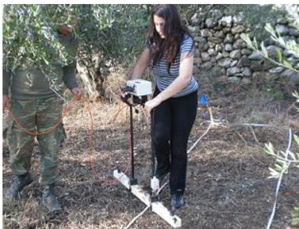
Σχήμα 2.2 Ηλεκτρομαγνητική διασκόπηση για χαρτογράφηση αρχαιολογικού χώρου
