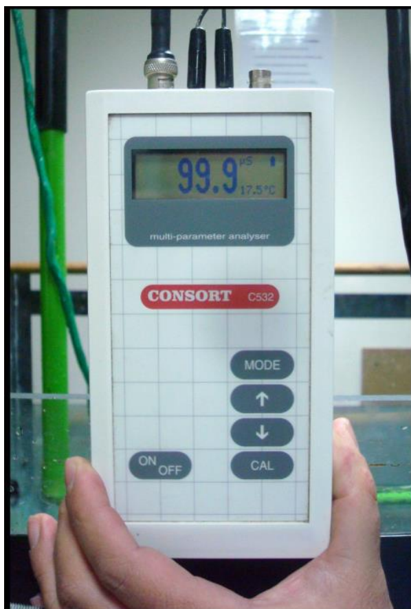
Σχήμα 4.2 Ειδικό όργανο υπολογισμού της αγωγιμότητας του μέσου (Consort, C532).
