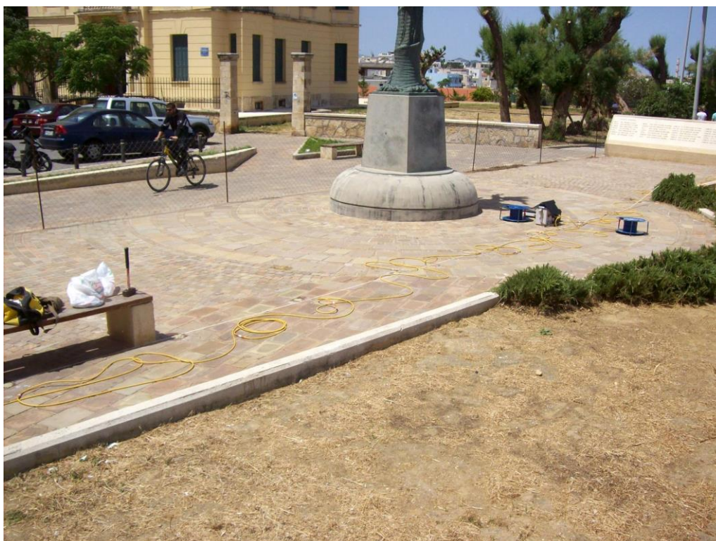
Φωτογραφία 4.1. Η γεωηλεκτρική τομή στην βίλα Κούνδουρου.
