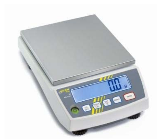
Εικόνα 4.2 Ψηφιακός ζυγός για το ζύγισμα θρεπτικών στοιχείων και την προετοιμασία των μητρικών διαλυμάτων
