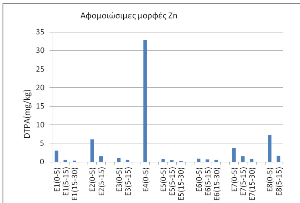
Διάγραμμα 4.32 Κατανομή αφομοιώσιμων μορφών Ψευδάργυρου ανα σημείο δειγματοληψίας και για τα 3 βάθη.
