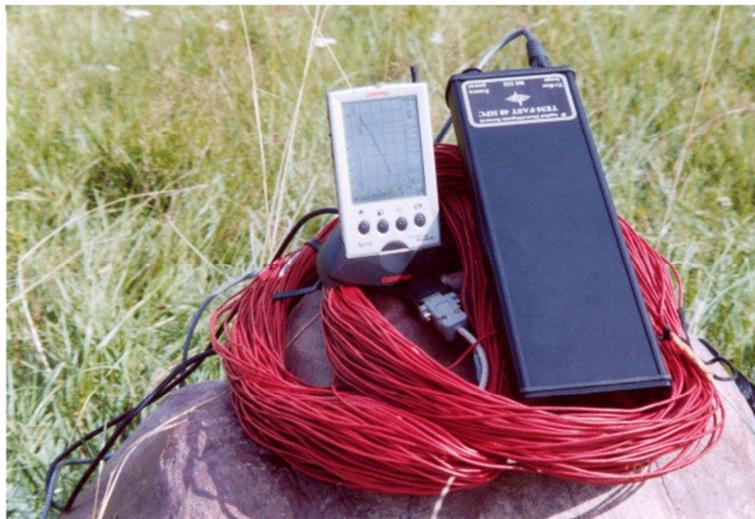
**Σχήμα 3.3.** Στη σχήμα παρουσιάζεται το TEM Fast 48 HPC, του οίκου AEMR. Το όργανο αποτελείται από τους βρόγχους (κόκκινα καλώδια υψηλής αγωγιμότητας), τη κεντρική μονάδα παραγωγής και διάθεσης των παλμών (συσκευή σε μαύρο χρώμα) και το μονάδα καταγραφής και αποθήκευσης (palmtop – υπολογιστής χειρός).
