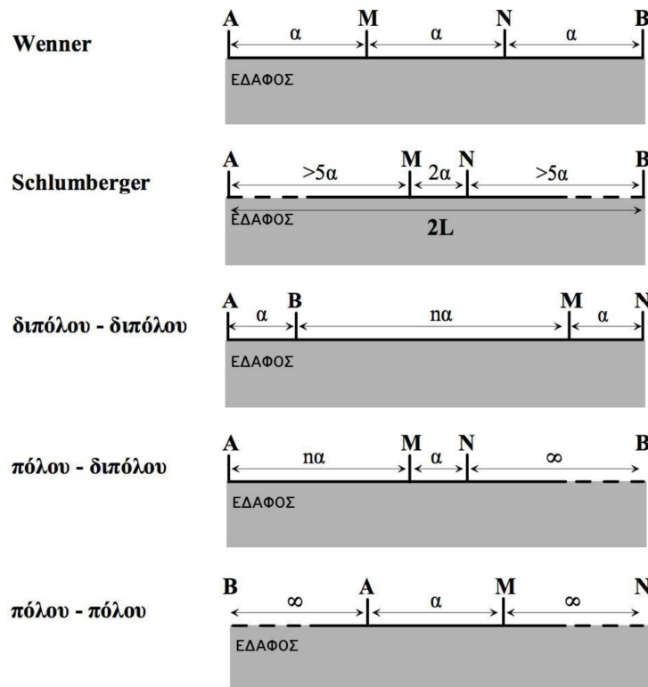
Σχήμα 2.4 Βασικές επιφανειακές διατάξεις ηλεκτροδίων (τροποποιήθηκε από Tsourlos, 1995).
