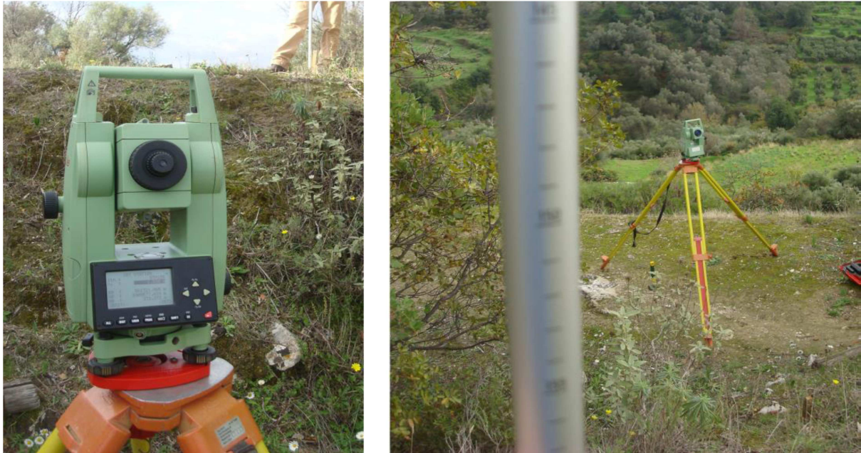
Σχήμα 4.3 Τοπογραφικός εξοπλισμός για τον ακριβή εντοπισμό της θέσης των ηλεκτροδίων.
