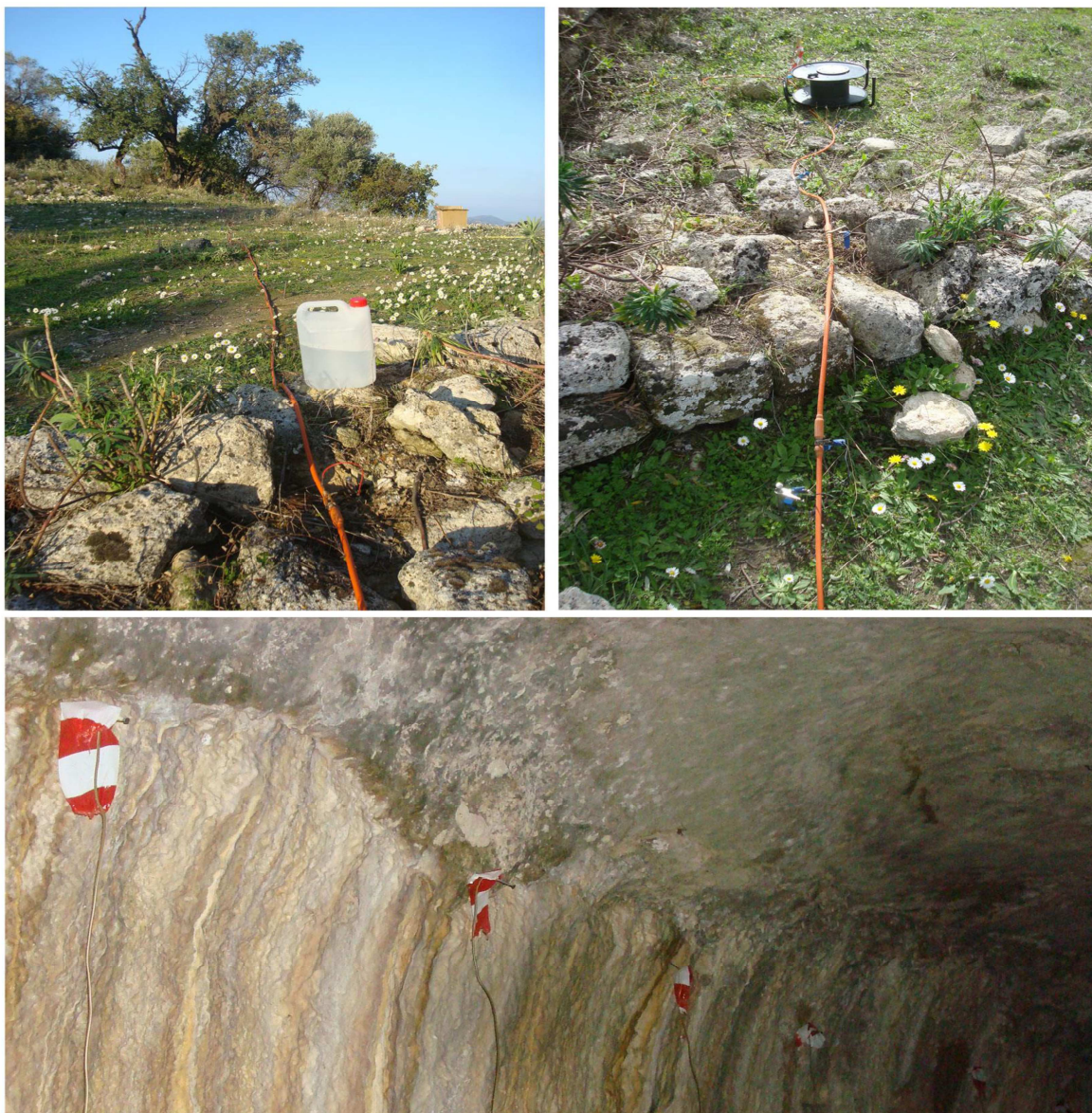
Σχήμα 4.4 Φωτογραφίες όπου απεικονίζεται το καλώδιο που χρησιμοποιήθηκε για τα επιφανειακά ηλεκτρόδια με κατεύθυνση προς την είσοδο (αριστερά), προς το τέλος (δεξιά) αλλά και στο εσωτερικό της σήραγγας (κάτω).
