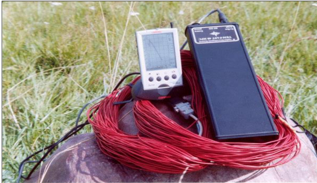
Εικόνα 3.9: Δείγμα οργάνου TEM- FAST 48 (APPLIED ELECTROMAGNETIC RESEARCH (AEMR) TEM - FAST 48HPC, aemr.net, 2010)
