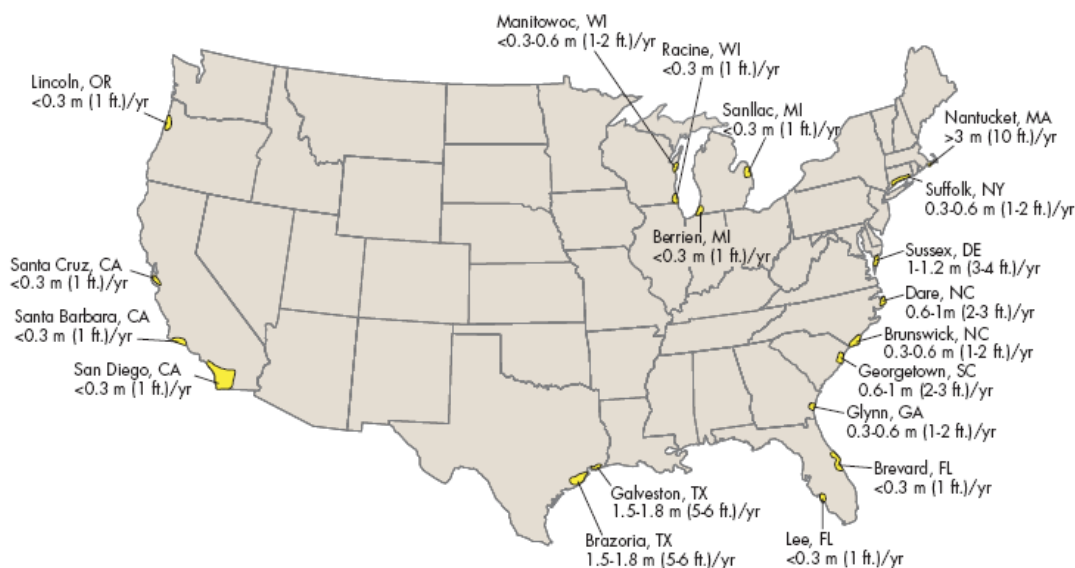
ΣΧΗΜΑ 1.9 ΡΥΘΜΟΙ ΠΑΡΑΚΤΙΑΣ ΔΙΑΒΡΩΣΗΣ Μέσοι ετήσιοι ρυθμοί διάβρωσης για επιλεγμένες επαρχίες στις ΗΠΑ (Modified from Evaluation of Erosion Hazards Summary: A Collaborative Project of the H. John Heinz III Center for Science, Economics and the Environment. Prepared for the Federal Emergency Management Agency. 2000. Online: http://www.fema.gov/nwz00/erosion.shtml )
