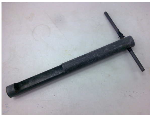
Φώτογραφία 6. Δειγματολήπτης άμμου & φιάλη 500 ml για δείγματα νερού
