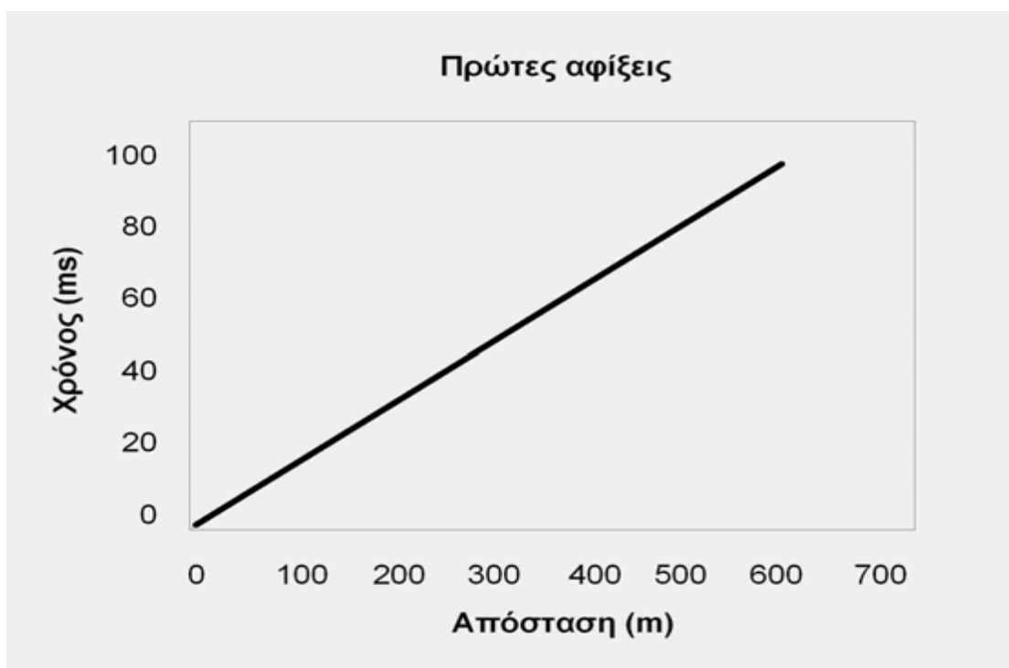
Σχήμα 3.47 Χρόνος διαδρομής της πρώτης άφιξης συναρτήσει της απόστασης από την πηγή (Αναπαραγωγή εικόνας από ThomasM. Boyd, 1999)
