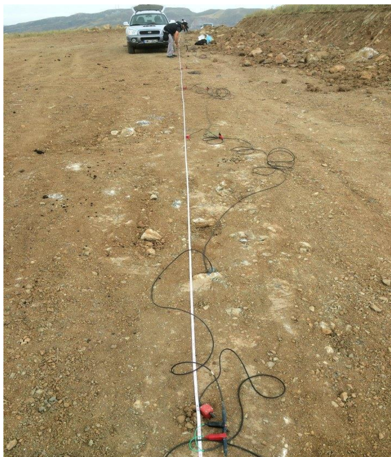
Σχήμα 3.28 Γεωφυσικό συνεργείο του Εργαστηρίου Γεωφυσικής και Σεισμολογίας του ΤΕΙ Κρήτης σε εργασία αναπτύγματος γραμμής γεωφώνων σε πλατώμα της ευρύτερης περιοχής της Μονής Αγίου Γεωργίου Επανωσήφη.
