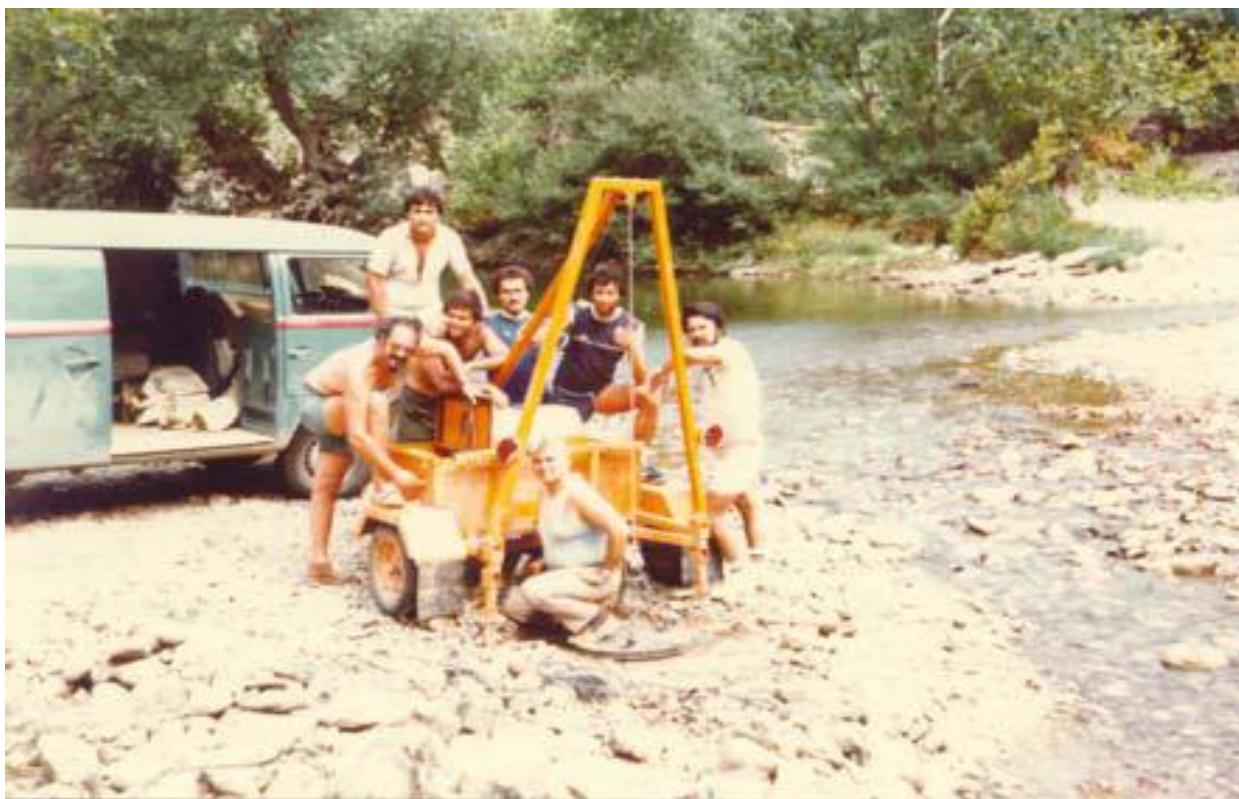
Σχήμα 3.21 Γεωφυσικό συνεργείο του Τομέα Γεωφυσικής του Πανεπιστημίου Αθηνών ενώ μεταφέρει τον μηχανισμό του πίπτοντος βάρους στη προβλεπόμενη θέση παραγωγής σεισμικής ενέργειας (1995, σεισμική έρευνα στο φράγμα Χαβρία, Χαλκιδική) [2].
