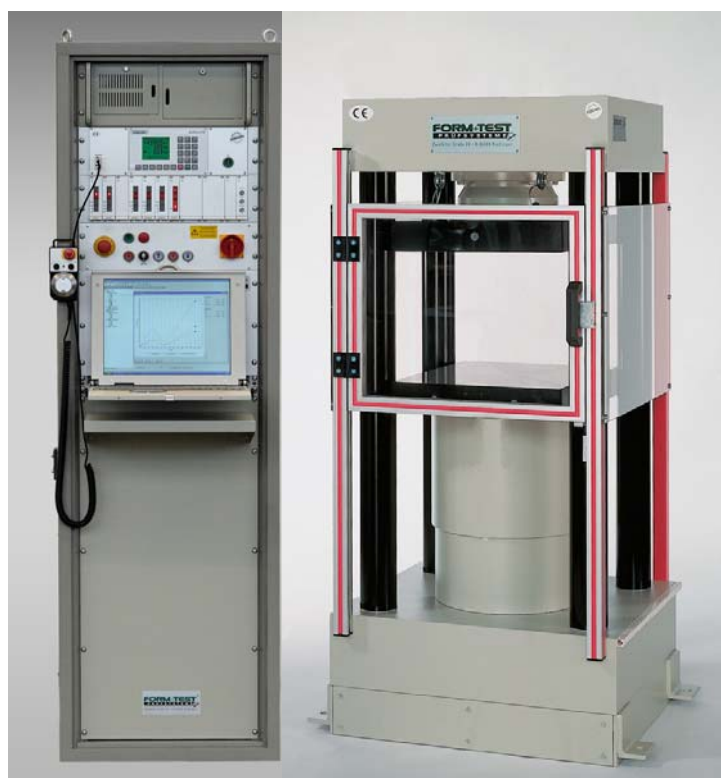
Σχήμα 3.17 Πλαίσιο μονοαξονικής φόρτισης και μονάδα ελέγχου ALPHA3-3000 (Form+Test, 3000kNt)
