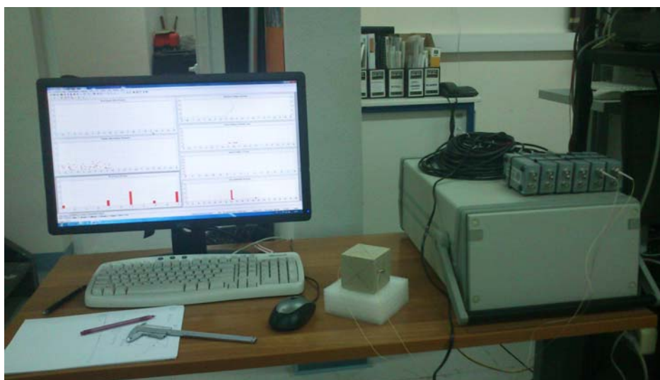
Φωτογραφία 4.2 Η πειραματική διάταξη για τον υπολογισμό της ταχύτητας διάδοσης των ακουστικών κυμάτων.
