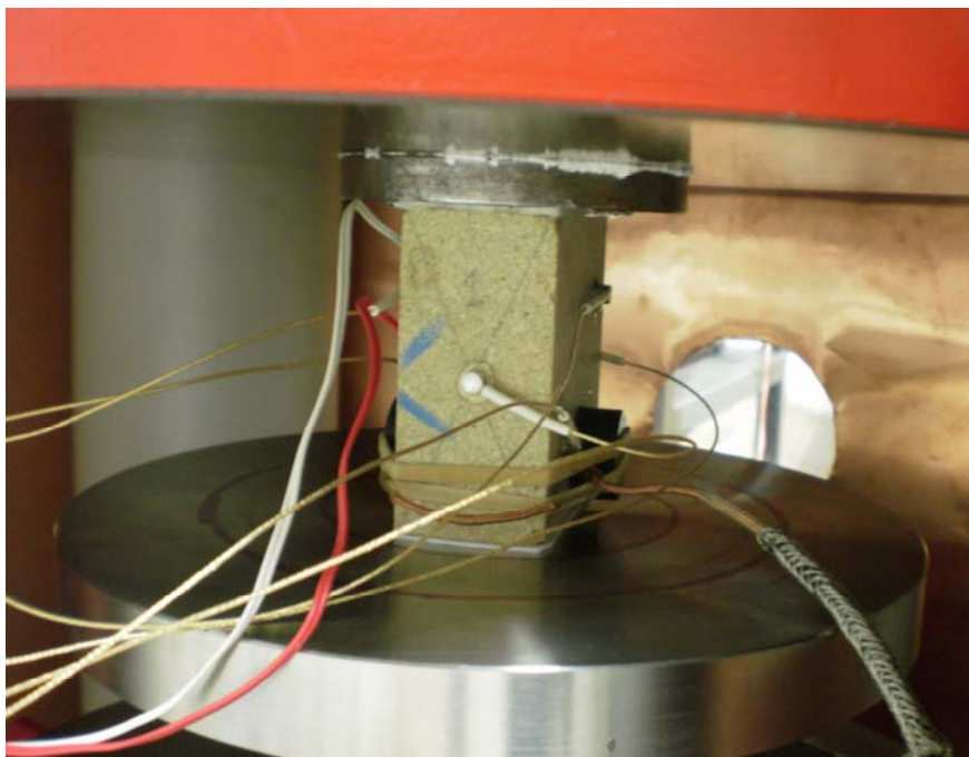
Φωτογραφία 3.2 Το πρισματικό δοκίμιο τοποθετημένο στη μηχανή φόρτισης. Διακρίνονται οι αισθητήρες AE και τα καλώδια του αισθητήρα strain gauge.
