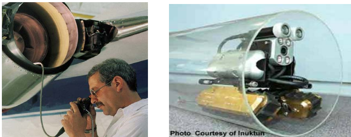
Σχήμα 1.1 Χρήση ενδοσκοπίου οπτικής ίνας και ρομποτικής ερπυστριοφόρου κάμερας για τον οπτικό έλεγχο μηχανών – αγωγών.
