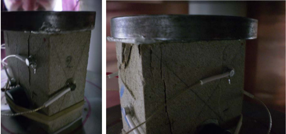
Φωτογραφία 4.3 Διαφορετικές όψεις του πρισματικού δοκιμίου μετά το τέλος της δοκιμής όπου διακρίνονται τα διάφορα επίπεδα θραύσης του και οι αποφλοιώσεις του.
