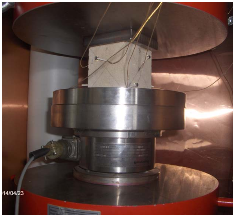
Φωτογραφία 3.4 Το κυβικό δοκίμιο τοποθετημένο στη συσκευή ανεμπόδιστης θλίψης, έτοιμο για τη δοκιμή.
