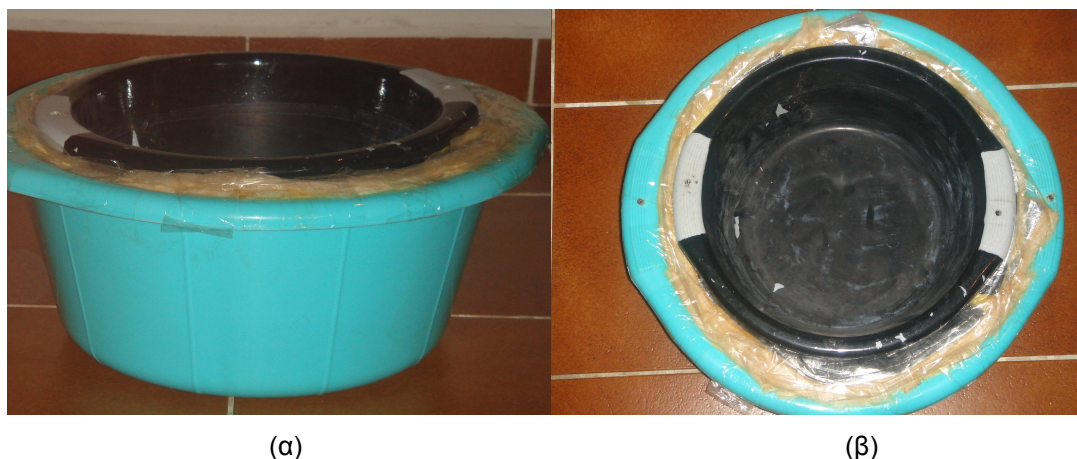
Εικόνα 2.1 α,β : φωτογραφίες από την κατασκευή του απλού ηλιακού θερμοσίφωνα χαμηλού κόστους
