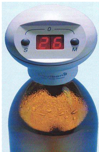
Εικόνα 7.12 : κεφαλή ψηφιακού αισθητήρα του B.O.D.
