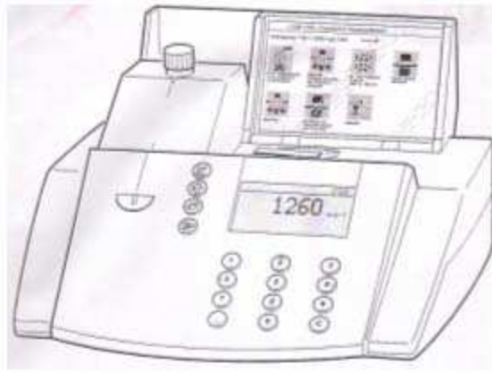
Εικόνα 7.9 :φωτόμετρο MERCK Spectroquant® NOVA 60.
