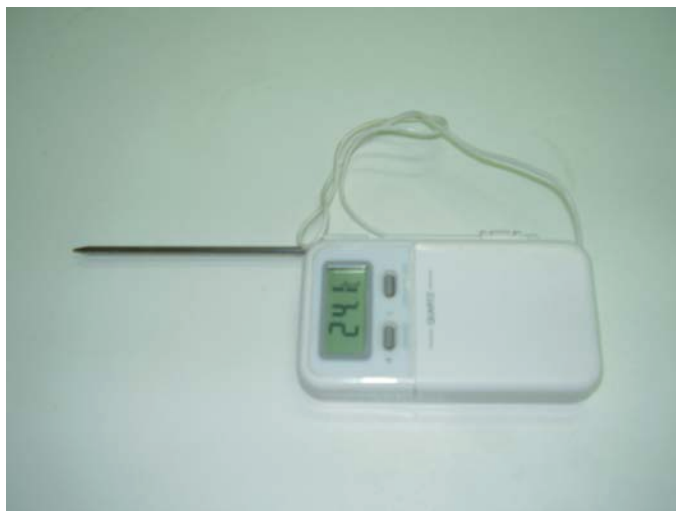
Εικόνα 7.5: ψηφιακό θερμόμετρο ακίδος που χρησιμοποιήθηκε στην λίμνη Κουρνά .
