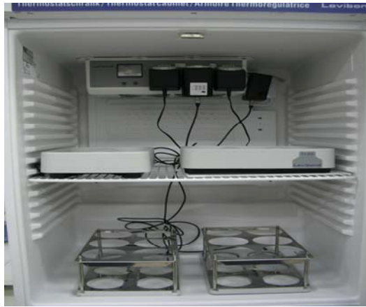
Εικόνα 7.11 : επωαστικός θάλαμος και βάση στήριξης B.O.D φιαλών.
