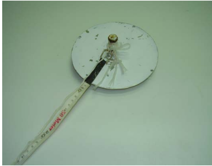
Εικόνα 7.2: δίσκος secchi που χρησιμοποιήθηκε για τις μετρήσεις στην λίμνη Κουρνά.
