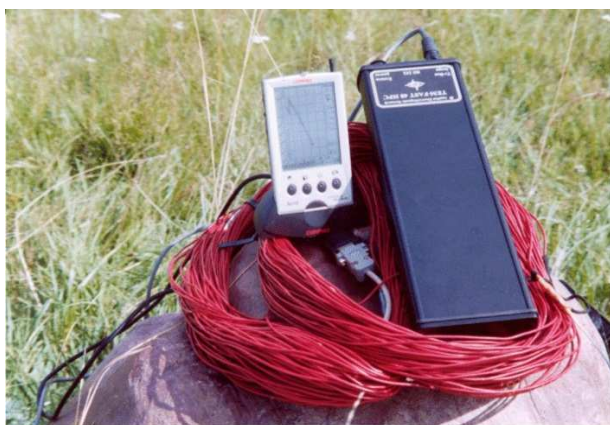
Σχήμα 3.4 Στη σχήμα παρουσιάζεται το TEM Fast 48 HPC, του οίκου AEMR. Το
