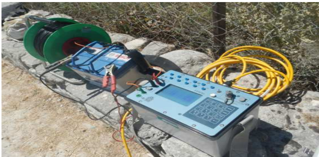
Τα παρελκόμενα των ηλεκτροδίων , είναι εμφανής η μονάδα ελεγχου και η μπαταρία
