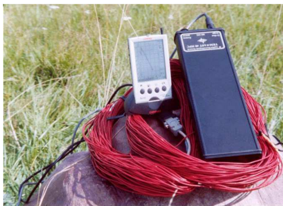
Σχήμα 7.3 Στη σχήμα παρουσιάζεται το TEM Fast 48 HPC, του οίκου AEMR. Το όργανο αποτελείται από τους βρόγχους (κόκκινα καλώδια υψηλής αγωγιμότητας), τη κεντρική μονάδα παραγωγής και διάθεσης των παλμών (συσκευή σε μαύρο χρώμα) και το μονάδα καταγραφής και αποθήκευσης (palmtop – υπολογιστής χειρός).
