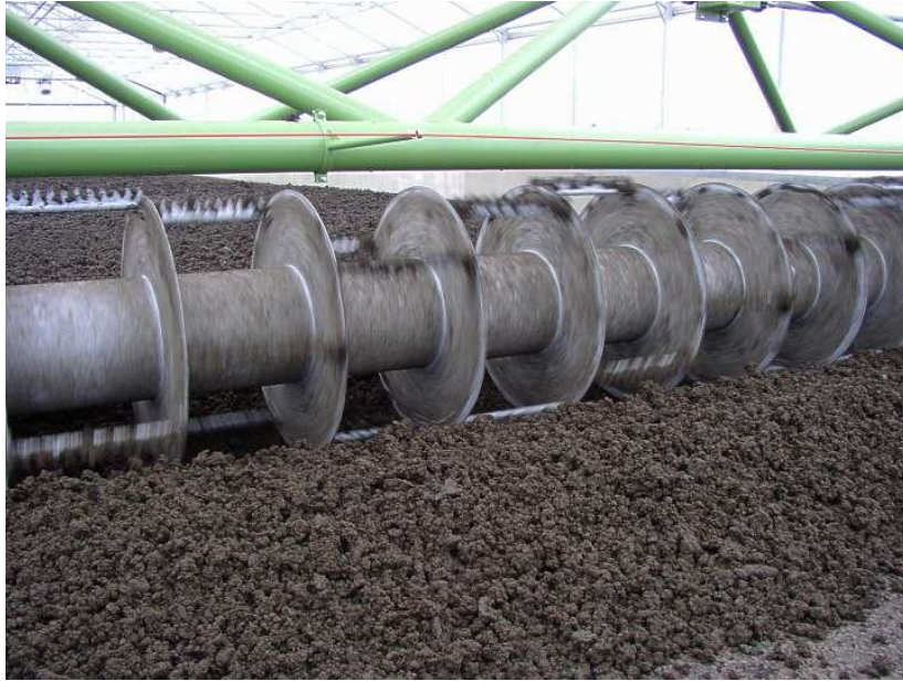
Εικόνα 2.3 «Ο αναδευτήρας του συστήματος Wendewolf®»
