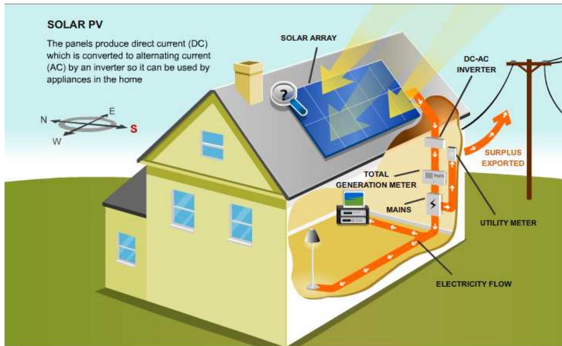
Εικόνα 2.37: Τρόπος λειτουργίας συστήματος φωτοβολταϊκών (Πηγή: www.energysavingtrust.org.uk )
