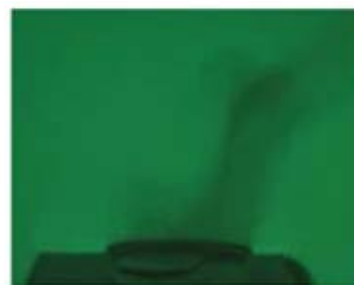
Εικ. 2.9: Ατμοί Hg 171 Οι άορατοι και επικίνδυνοι ατμοί υδραργύρου δημιουργούν σκιά σε φθορίζον πέτασμα, όταν αυτό φωτίζεται με υπεριώδη ακτινοβολία.
