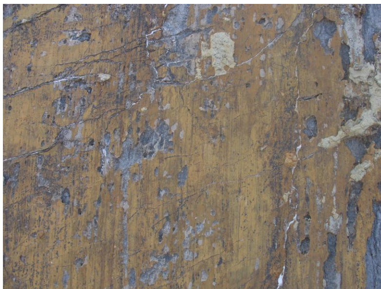
Σχήμα 3.6. α Ρηξιγενής επιφάνεια και β γραμμές ολίσθησης.
