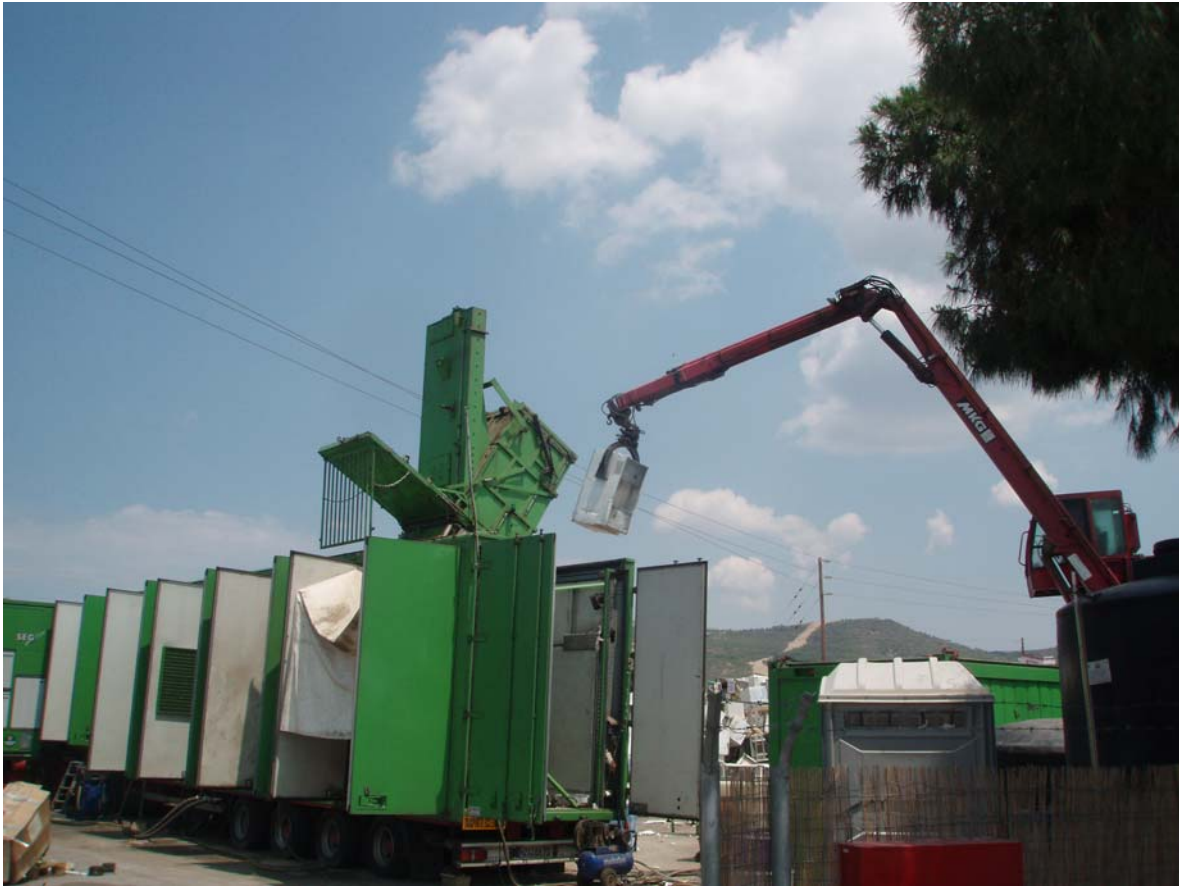
Εικόνα 6.11 Διαδικασία απορρύπανσης συσκευής ψυγείου στις εγκαταστάσεις του Ε.Κ.ΑΝ. (Αγ. Θεόδωροι,Κόρινθος) - Πηγή: Μαγόπουλος Μάριος 15/05/2008
