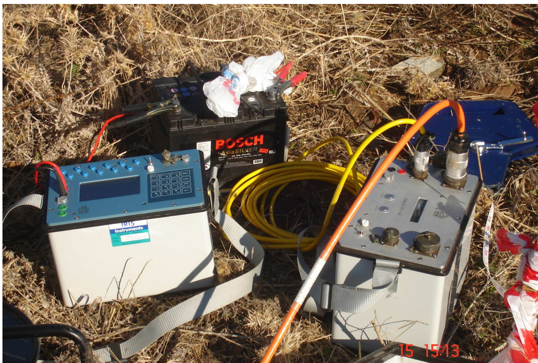
Εικόνα 4.1: Φωτογραφία του οργάνου μέτρησης της αντίστασης του εδάφους SYSICAL Pro (αριστερά πάνω) και του πολυπλέκτη SYSICAL Switch Pro (δεξιά πάνω). Τρόπος σύνδεσης του οργάνου SYSICAL Pro με τον πολυπλέκτη για την αυτόματη μέτρηση και καταγραφή της φαινόμενης αντίστασης του υπεδάφους (κάτω).
