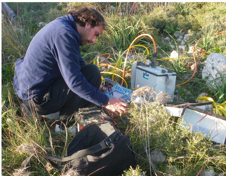
Εικόνα 4.2: Λεπτομέρειες από την διεξαγωγή των μετρήσεων της ηλεκτρικής τομογραφίας στην περιοχή Ξανθουλιανά με το όργανο SYSCAL Pro και SWITCH Pro 96.
