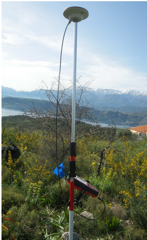
Εικόνα 4.5: Όργανο μέτρησης GPS LEICA GS20 για την εύρεση των συντεταγμένων στη περιοχή έρευνας
