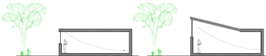
Εικόνα 3.6: Επίδραση της θέσης του παραθύρου στην κατανομή φυσικού φωτισμού
