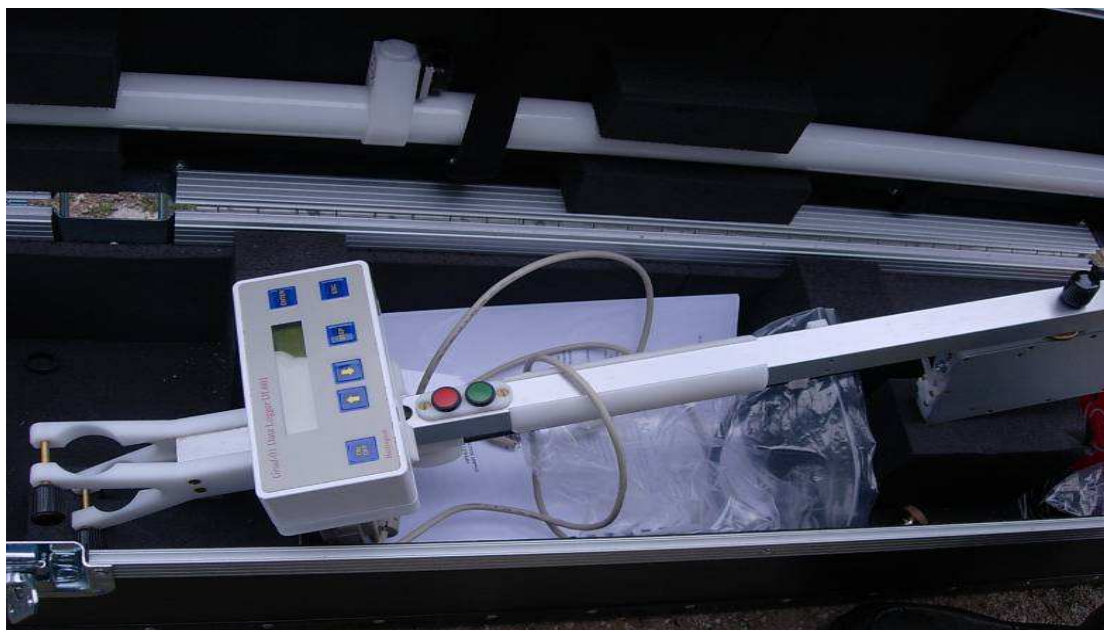
Εικόνα 3.5. Το διαφορικό μαγνητόμετρο ροής Bartington Instruments Grad601.
