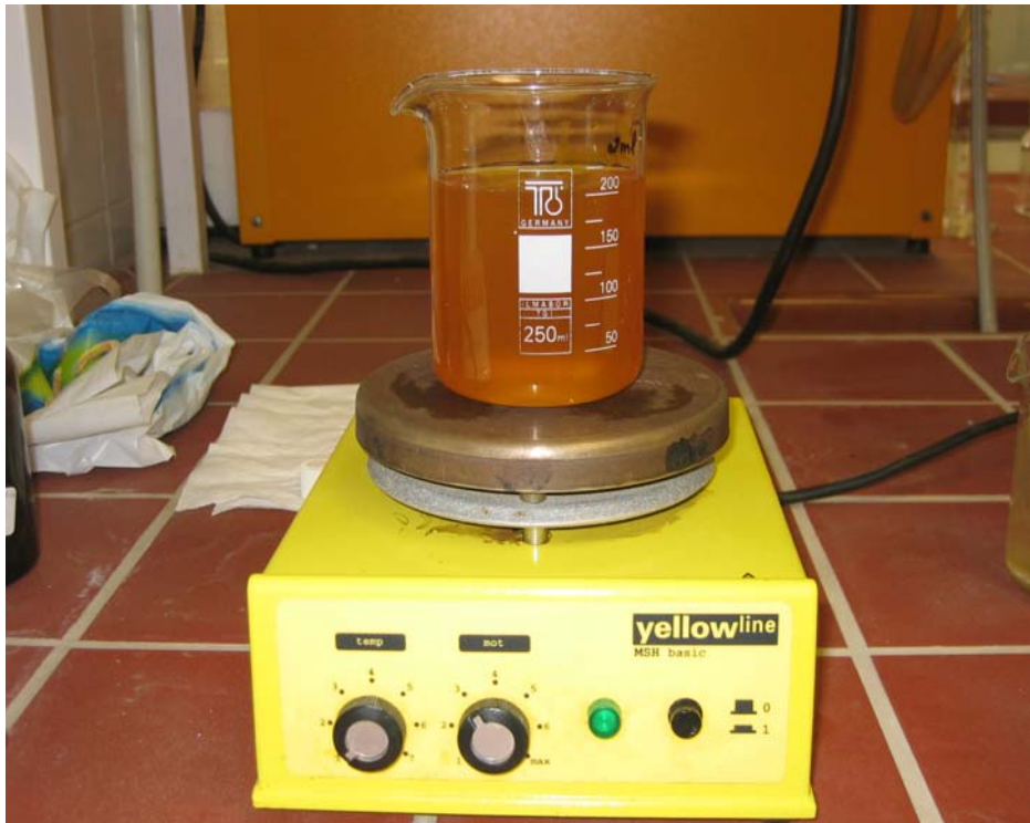
Εικόνα 7.4. : Ανάδευση των δειγμάτων για 15 min, σε θερμοκρασία δωματίου ( 22^{\circ}C - 24^{\circ}C ).
