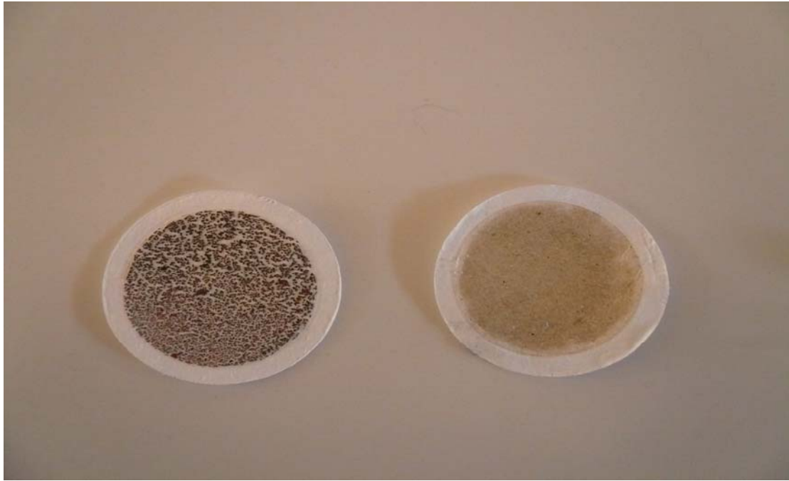
Εικόνα 8.29.: Ολικά αιωρούμενα στερεά μετά από διήθηση 50 mL δείγματος λυμάτων που περιείχε 296,5 mg FeCl_3/L (αριστερά) και ανεπεξέργαστου δείγματος λυμάτων χωρίς την προσθήκη FeCl_3 (δεξιά).
