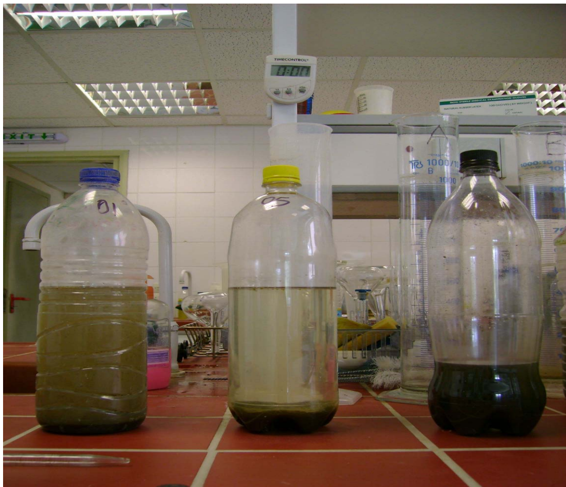
Εικόνα 8.22. : Το πρώτο από αριστερά μπουκάλι περιέχει 1Lr λυμάτων με 59,3 \text{ mg } FeCl_3 / L βοθρολυμάτων (0,1 mL/L Ferrisol 140), το μεσαίο μπουκάλι περιέχει 1Lr λυμάτων με 296,5 \text{ mg } FeCl_3 / L βοθρολυμάτων (0,5 mL/L Ferrisol 140) και το μπουκάλι στα δεξιά της φωτογραφίας περιέχει λύματα χωρίς Ferrisol 140. Η φωτογραφία είναι τραβηγμένη μετά από 10' ανάδευσης 3,5 ώρες καθίζησης.
