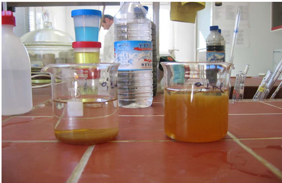
Εικόνα : 8.18. : Δοχεία που περιέχουν λύματα με 296,5 \text{ mg } FeCl_3 / L λυμάτων. (αριστερά) μετά από 1 h καθίζηση, (δεξιά) μετά από 15' ανάδευση.
