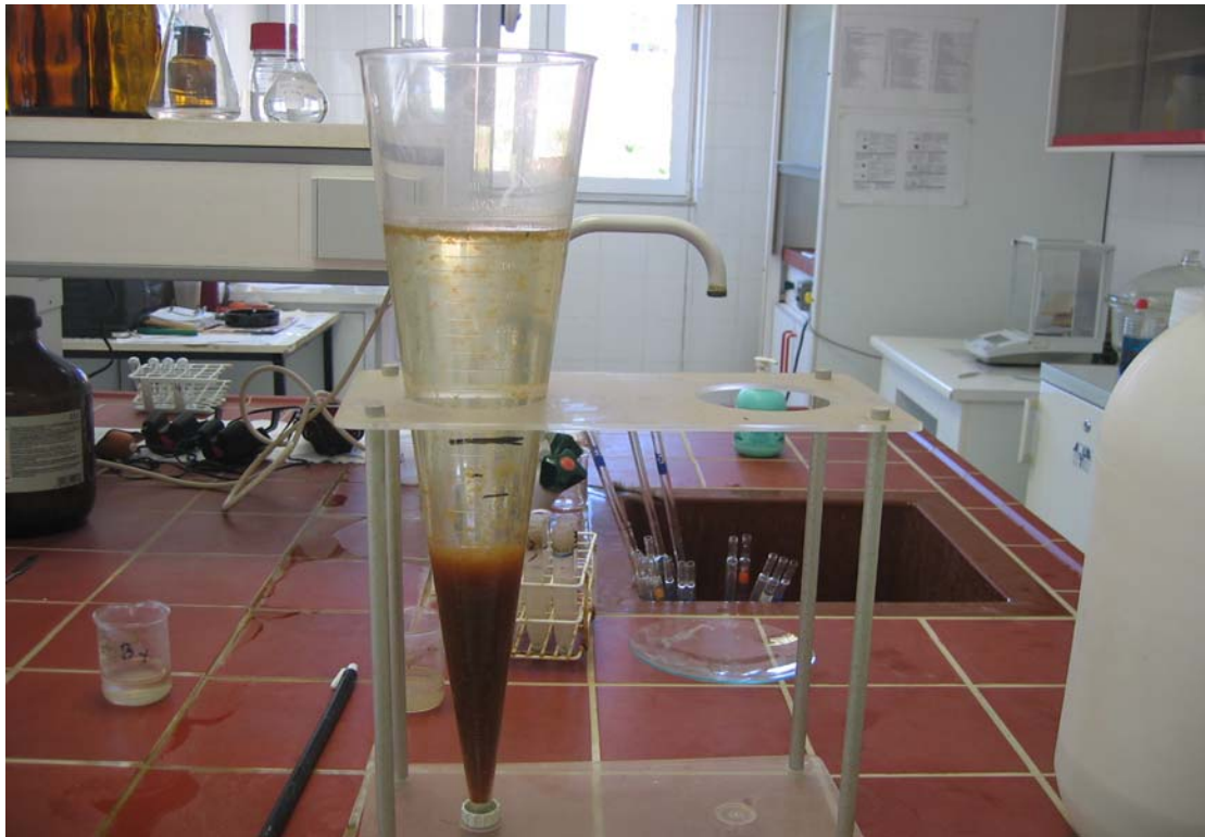
Εικόνα 8.7. : 1L λυμάτων με 296,5 mg FeCl_3 /L σε κώνο Imhoff μετά από ~ 30 min καθίζηση.
