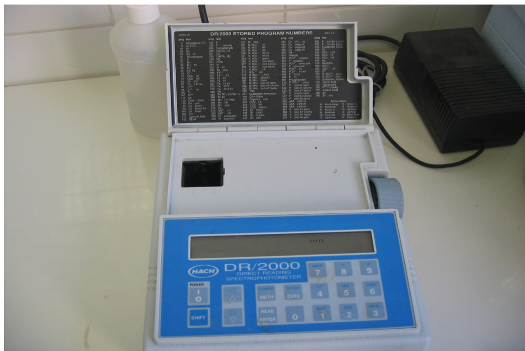
Εικόνα 7.9. : Μετρητής σουλφιδίων φωτόμετρο HACK.
