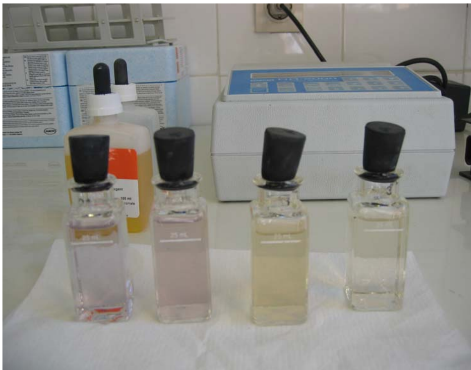
Εικόνα 7.8. : Τα μπουκαλάκια του φωτόμετρου HACK όπου μεταφέρουμε το δείγμα μετά την φυγοκέντρηση για τον προσδιορισμό των σουλφιδίων ( S^{2-} ).
