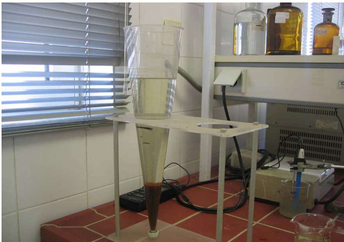
Εικόνα 8.8. : 1L λυμάτων με 296,5 mg FeCl_3 /L σε κώνο Imhoff μετά από 3,5 ώρες καθίζησης.
