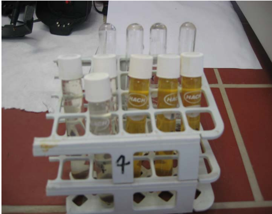
Εικόνα 7.6. : Προσθήκη των δειγμάτων στους σωλήνες για την διαδικασία της φυγόκέντρωσης.
