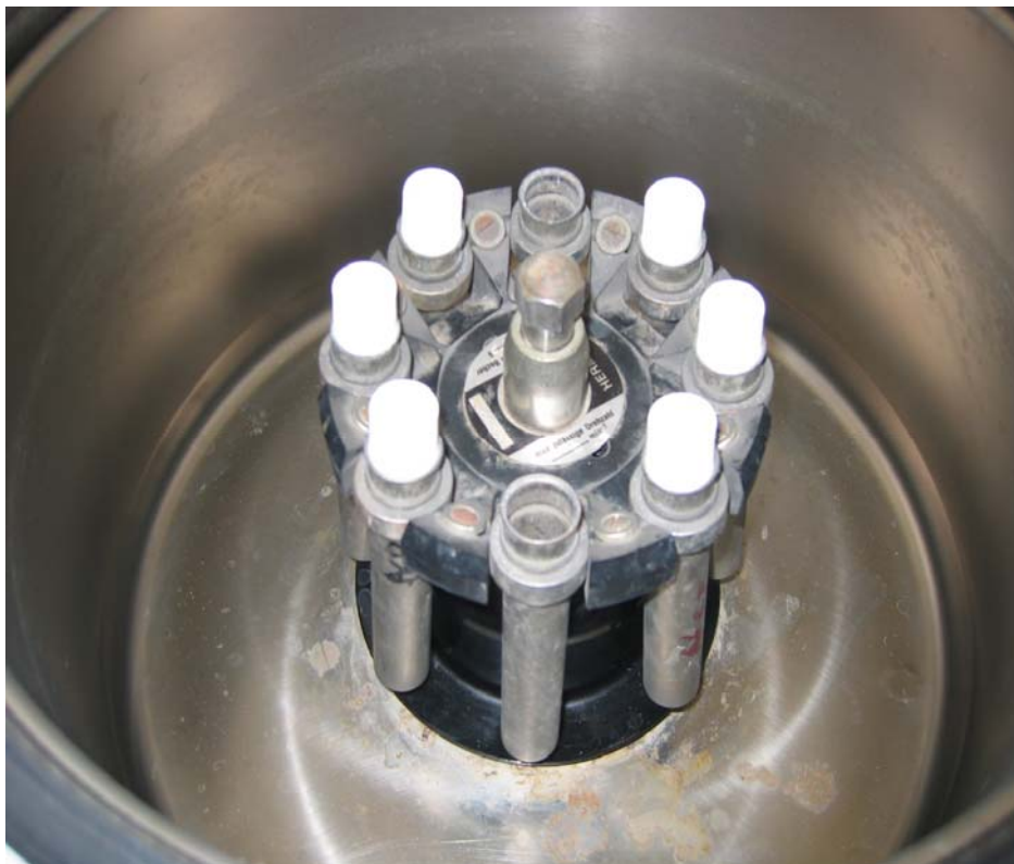
Εικόνα 7.7. : Απεικόνιση της φυγόκεντρου που χρησιμοποιήθηκε στη μονάδα επεξεργασίας υγρών αποβλήτων της Δ.Ε.Υ.Α.Χ.
