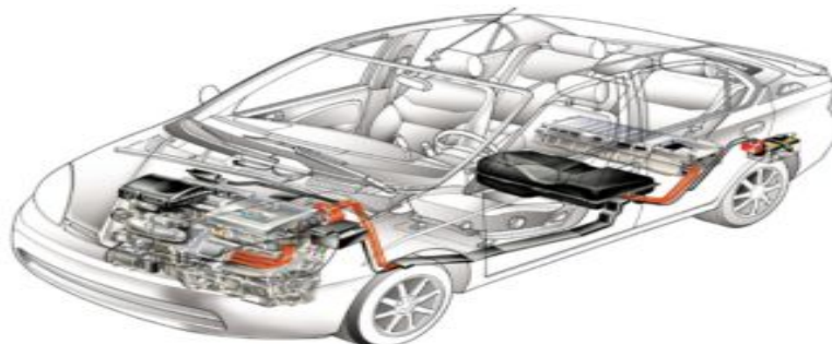
Σχήμα 4.11: Σχηματική παράσταση συστήματος τροφοδοσίας ενός υβριδικού αυτοκινήτου [24].
