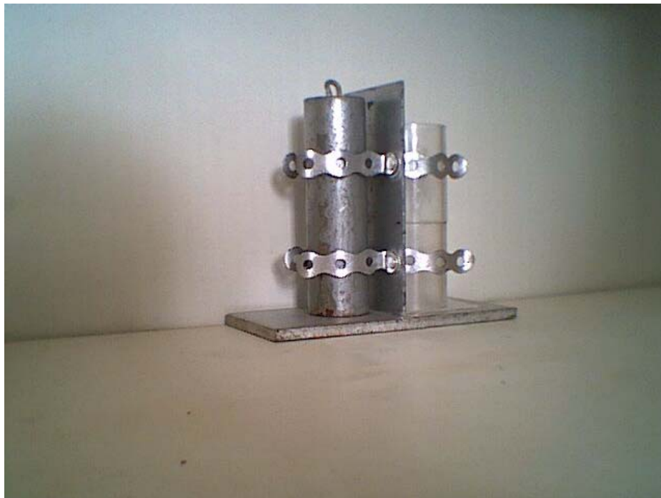
Φωτογραφία 1: Μηχανισμός για την εφαρμογή της μεθόδου προσδιορισμού pH & E.C. με τη μέθοδο 1: 1 ½ (V/V)
